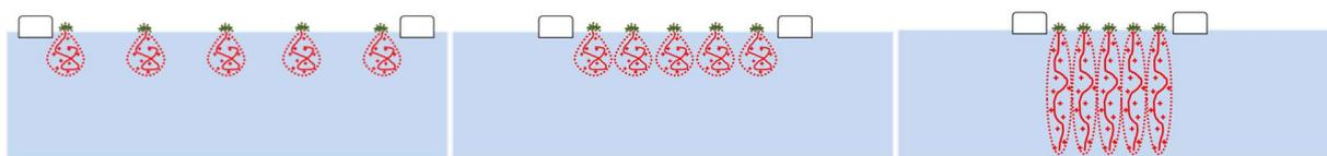
Figure 38 : Représentation schématique d'une conformation champignon en phase gaz de pression de surface nulle (à gauche), au début de l'augmentation de la pression de surface (au milieu) ainsi qu'en phase brosse (à droite). Les rectangles blancs représentent les barrières de la cuve de Langmuir.
