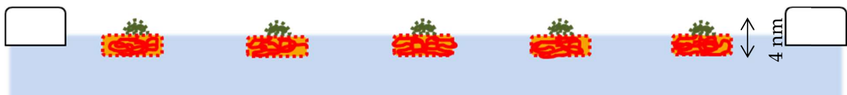
Figure 90 : Représentation schématique d'une monocouche de PS-PDMAEMA sur une sous-phase acide contenant 10^{-4} \text{ mol} \cdot \text{L}^{-1} d' \text{AuCl}_4^- . Les chaînes PS sont représentées en vert, les chaînes PDMAEMA en rouge et la couleur zone représente des régions densément chargées en ions or.
