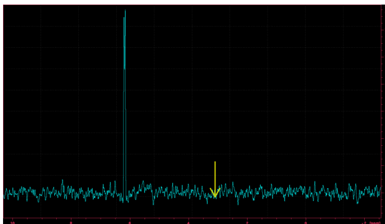
Figure A.22: Spectre 1D DAN sélectif (expérience 1D « selzg ») centrée sur O 1 P (3,351 ppm) et montrant uniquement la composante (déblindée) du DQ du co-solvant de l'échantillon ( P_{11} = 300 ms, SPdB_1 = 60 dB, SPNAM1 = tt-11-19-2 , NS = 32 ).
