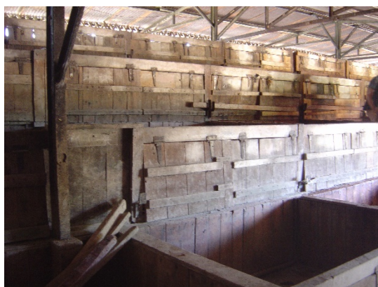
Figure 8. Fermentation des fèves dans des bacs en cascade
