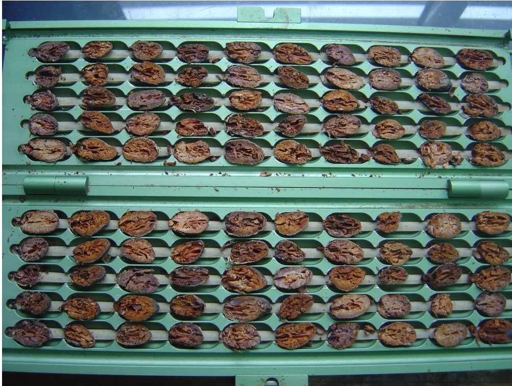
Figure 6. Coupe de 50 fèves à l'aide d'une guillotine (Magra 12, Teserba)
