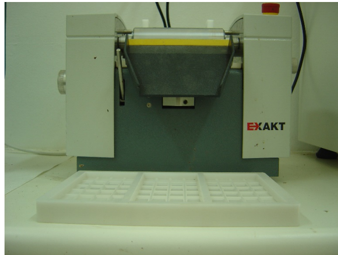
Figure 5. Raffineur à 3 rouleaux (marque Exakt)
