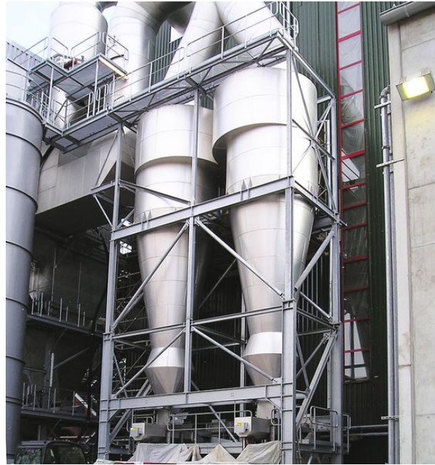
FIGURE 1.5: À gauche : schéma simplifié d'un cyclone, utilisant la force centrifuge pour effectuer une séparation mécanique des particules en suspension dans un gaz. Les particules sont entraînées vers la paroi, où elles perdent leur quantité de mouvement par friction, et finissent par chuter. Ce dispositif est fréquemment mis en oeuvre pour la décontamination de rejets gazeux dans l'atmosphère (source : wikipedia). À droite : cyclone implanté sur un site industriel (source : www.scheuch.com ).
