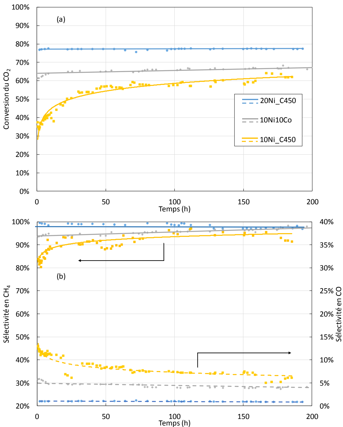
Figure IV.10. Conversion du CO 2 (a), Sélectivité en CH 4 et CO (b) pendant les 200 h de tests de stabilité, GHSV = 133333 \text{ mL}\cdot\text{gcat}^{-1}\cdot\text{h}^{-1} , H_2/CO_2=4/1 , T= 350 \text{ }^\circ\text{C} , m_{\text{cata}}=0,09 \text{ g}
