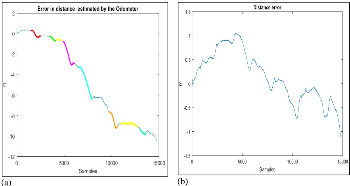
Figure 70. La différence entre la distance parcourue réelle et celle donnée par les odomètres
