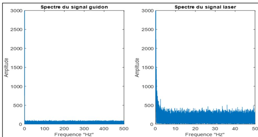
Figure 43. Le spectre du bruit dans les données des capteurs guidon et lasers.
