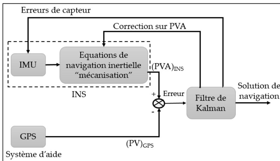
Figure 34. Mode faiblement couplé en boucle fermée
