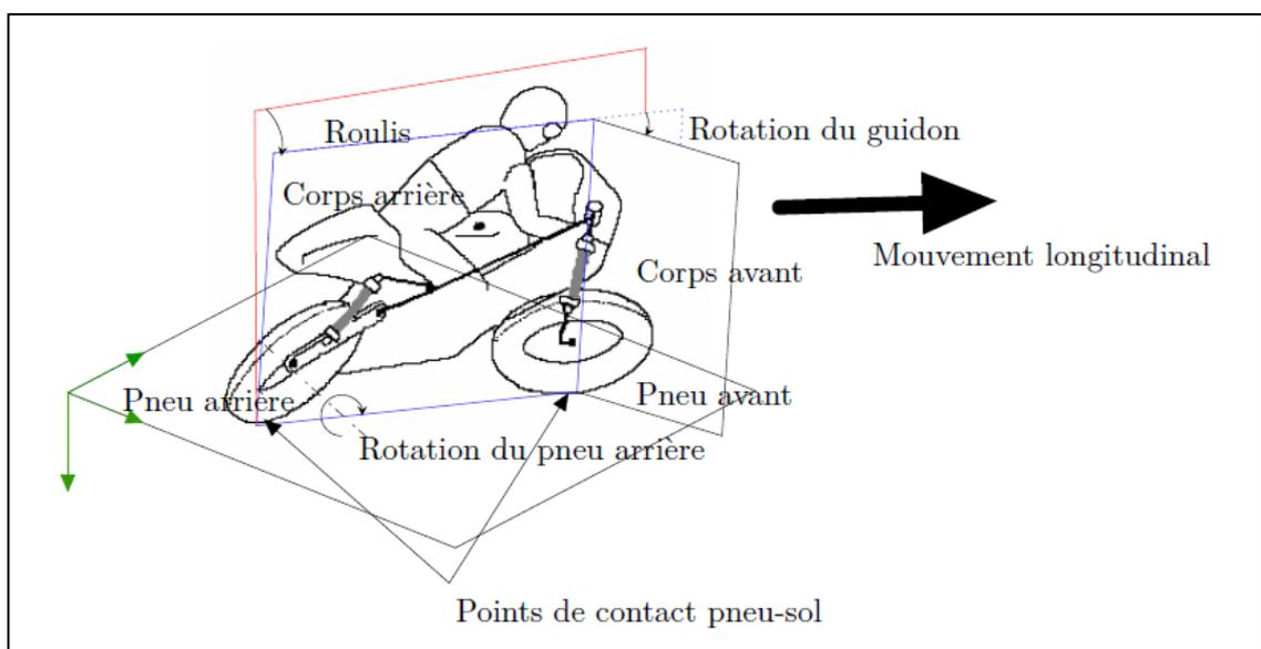
Figure 11. Les principaux mouvements d'un véhicule deux-roues motorisé.
