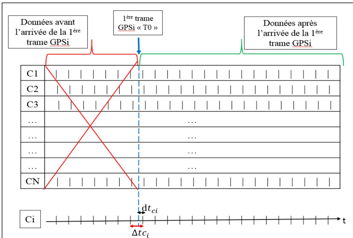
Figure 54. Relations temporelles entre les divers capteurs
