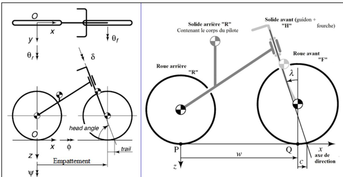
Figure 26. Les paramètres du modèle bicyclette
