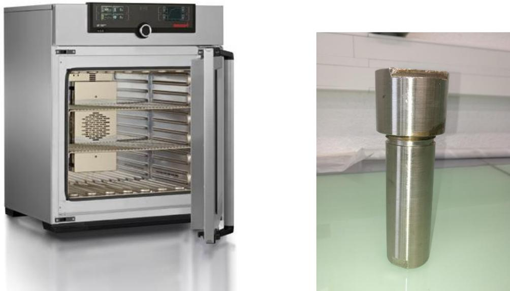
*Figure 7.1 : De gauche à droite, photos de l'étuve et du réacteur autoclave employés lors de la synthèse des échantillons*
