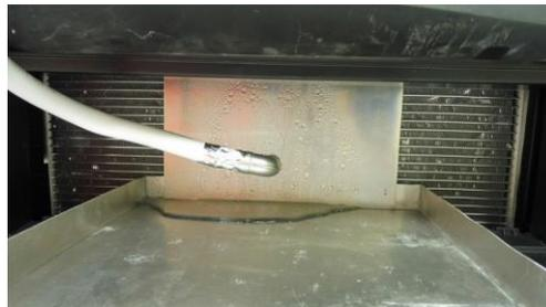
Figure 43 – Mesure du taux d'évaporation
