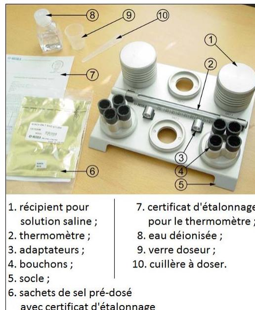
Figure 121 – Sels d'étalonnage (© Vaisala)
