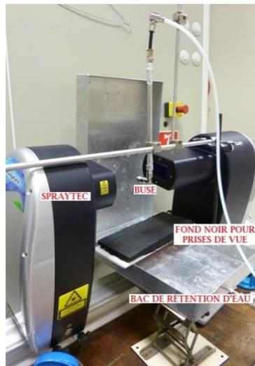
Figure 46 – Installation utilisée pour le Spraytec
