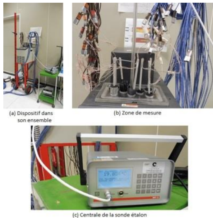
Figure 120 – Dispositif d'étalonnage des thermocouples
