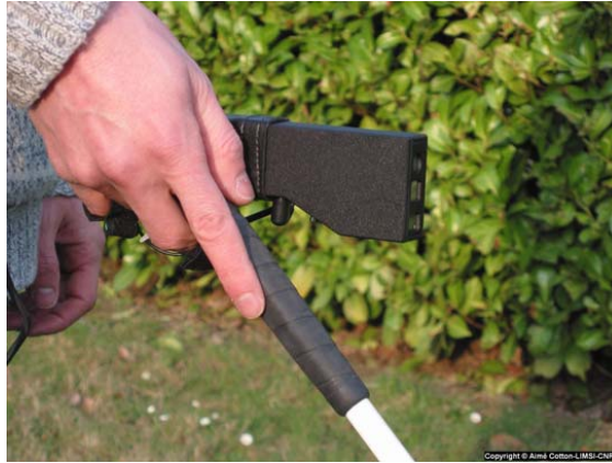
FIGURE 2.4 – Un Teletact (capteur laser) monté sur une canne blanche [Farcy et al., 2006].
