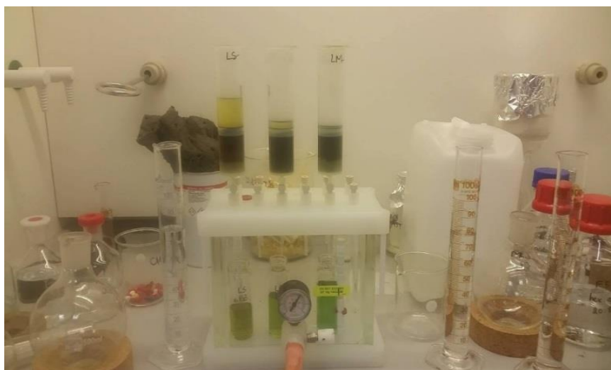
Figure 13. Montage du fractionnement SPE en phase normale (© J. Gaubert).
