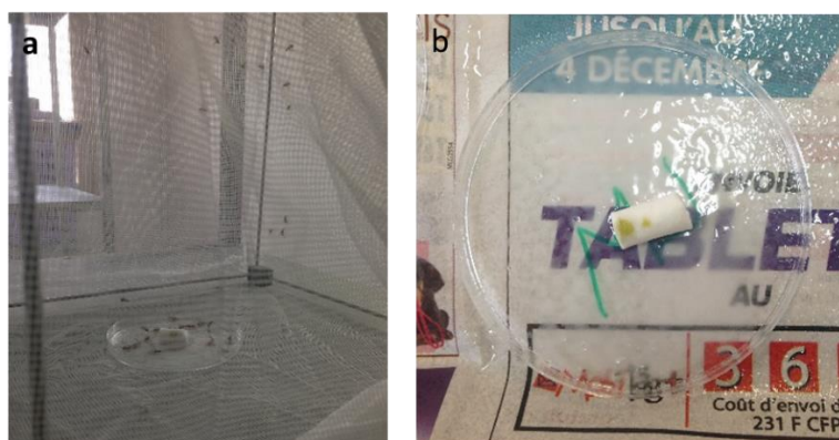
Figure 27. (a) Aperçu de la cage : les mouches attirées par la substance sur le coton dentaire restent collées dans la boîte de Pétri. (b) Boîte de Pétri recouverte de colle et contenant le coton dentaire sur lequel l'extrait à tester est déposé (© J. Gaubert).
