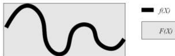
Figure 1. 10. Effet enveloppant : le pavé gris est le plus petit pavé contenant l'image (en noir) de la fonction f
