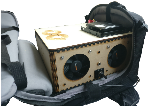
(d) Wooden box protecting the MIMOSA board.
