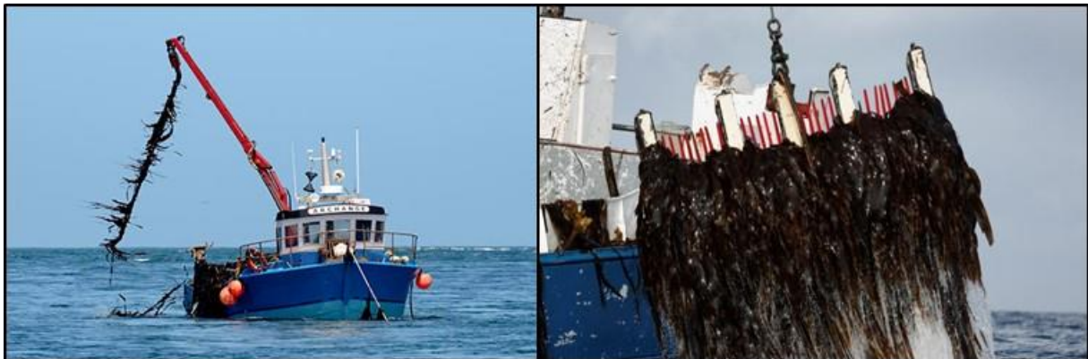
Figure 14 : Outils de récolte des laminaires de la flottille Française. (a) le 'scoubidou' pour la récolte de L. digitata (crédit photo : Fabien Boileau / Agence française pour la biodiversité), (b) le 'peigne norvégien' pour la récolte de L. hyperborea (crédit photo : CRPM Bretagne)
