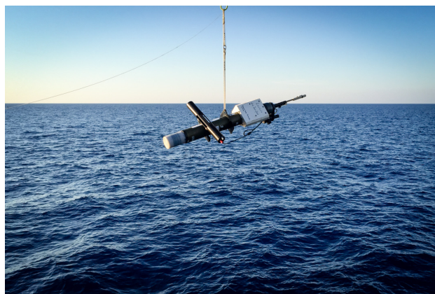
Figure 2.9: Déploiement durant la campagne PEACETIME du flotteur profileur lovbio112b (WMO: 6902828) avec le transmissiomètre c-Rover installé en position horizontale (Crédit photo N. Haëntjens)
