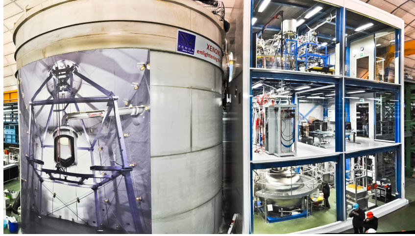
Fig. 4.4 – Photographie de l'installation de XENON1T. À gauche, le réservoir d'eau, contenant le cryostat et la TPC et servant à la fois de veto à muons et de blindage externe. Un poster représentant l'intérieur du réservoir permet de visualiser le cryostat. À droite, un bâtiment de trois étages permet de faire fonctionner l'expérience. Au rez-de-chaussée : un système de stockage permettant de récupérer le xénon liquide en cas d'urgence et une colonne de distillation cryogénique. Au premier étage : le système électronique et le système d'acquisition des données (DAQ). Au dernier étage : le système de purification et de cryogénie du xénon liquide.
