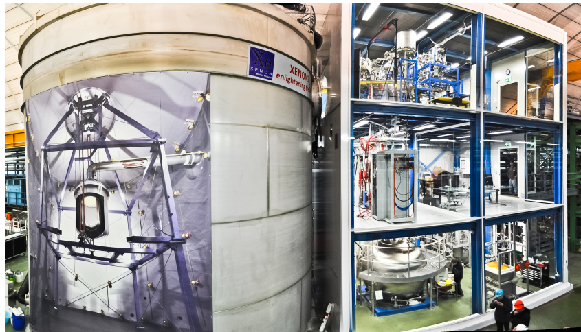
Fig. 4.4 – Photographie de l'installation de XENON1T. A gauche, le réservoir d'eau, contenant le cryostat et la TPC et servant à la fois de veto à muons et de blindage externe. Un poster représentant l'intérieur du réservoir permet de visualiser le cryostat. A droite, un bâtiment de trois étages permet de faire fonctionner l'expérience. Au rez-de-chaussée : un système de stockage permettant de récupérer le xénon liquide en cas d'urgence et une colonne de distillation cryogénique. Au premier étage : le système électronique et le système d'acquisition des données (DAQ). Au dernier étage : le système de purification et de cryogénie du xénon liquide.
