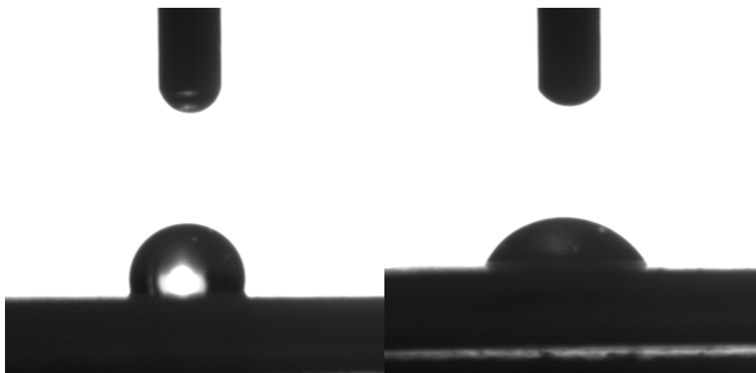
Figure II.45 - Clichés utilisés pour la mesure d'angles de contact. Ici une goutte d'eau sur un PP non traité (gauche), et sur un PP traité par plasma (droite).
