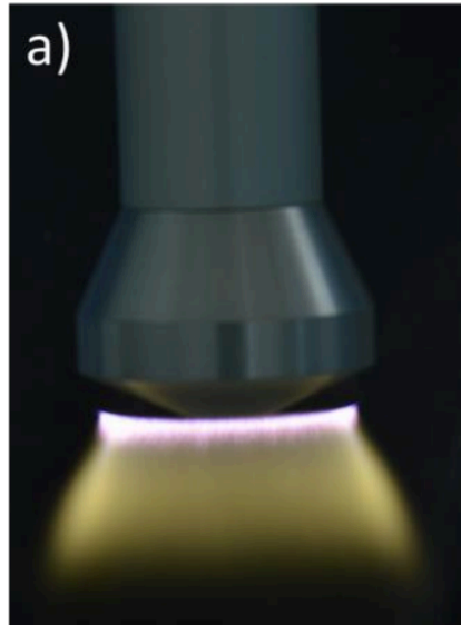
Figure I.25 – Exemple de plasma généré par une torche à plasma rotative
