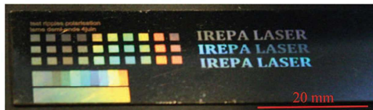
Figure 1.11 Changement de couleur de l'acier inox en fonction de la polarisation du laser de gravure [39].
