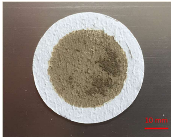
Figure 5.7 Filtre en fibres de quartz avec un dépôt de particules généré par gravure laser de l'ABS-PC.
