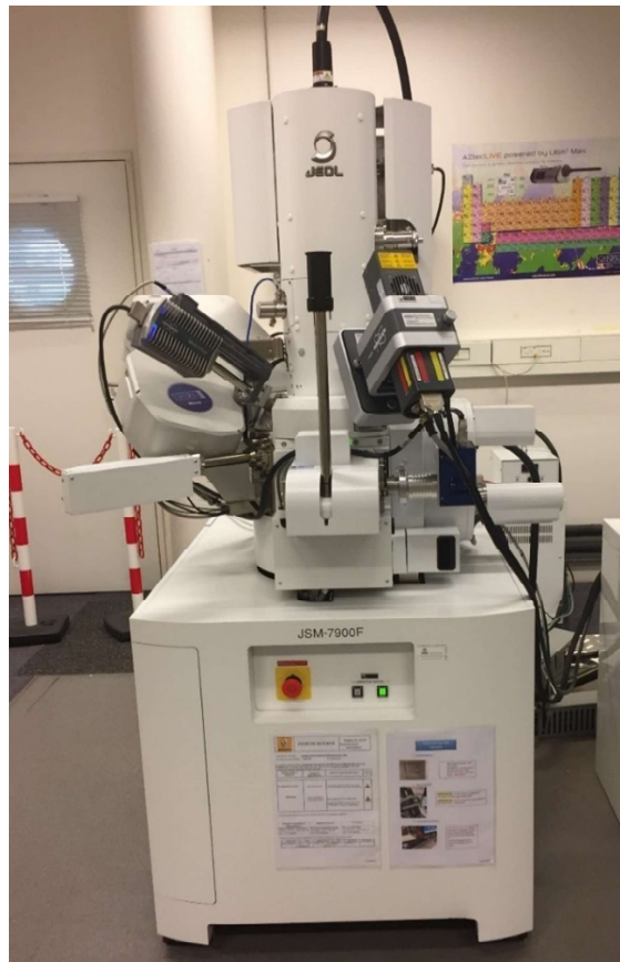
Figure 2.48 Microscope Electronique à Balayage (MEB) au sein du laboratoire RENAULT service DEA – TC.
