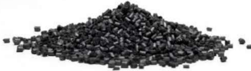
Figure 2.14 Granulés de plastique pour injection.
