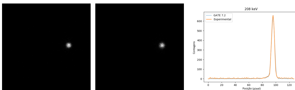
FIGURE 12 – Projection 120 de la source en périphérie sous l'eau avec la G&E Optima 640 3/8: Images expérimentales (à gauche), simulées (au centre) et profil de projection (à droite).
