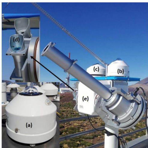
Figure 18: instruments des stations du réseau BSRN
