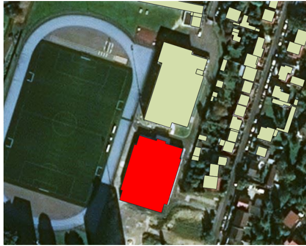
FIGURE III.21. Bâtiment réel (en rouge) absent de la BD TOPO® (bâti jaune)
