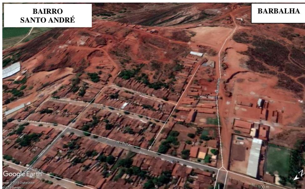
**Figure 5.5.** Le quartier Santo André à Barbalha. Urbanisation récente sur une colline de grès argileux tendres aux pentes découpées et partiellement ravinées, à l'amont du Riacho Seco (non apparent sur l'image). Les rues tracées dans le sens de la pente facilitent l'écoulement des eaux de ruissellement. Image Google Earth, 2018.
