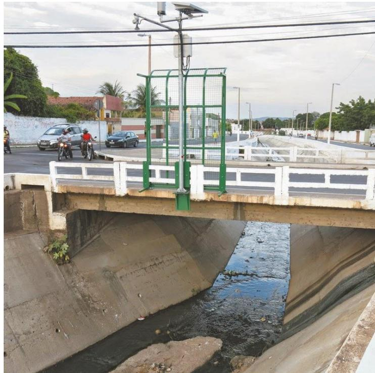
**Figure 6.31** : Plateforme de collecte de données hydrologiques (pluviométrie, hauteur d'eau, débit) installée en 2014 sur le Canal do Rio Granjeiro, Crato. (Source : <https://www.blogcariri.com.br/2014/12/crato-ce-plataformas-de-dados.htm>).
