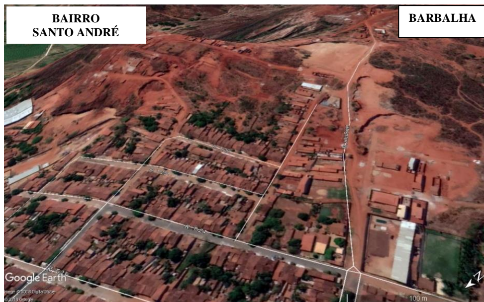
Figure 5.5. Le quartier Santo André à Barbalha. Urbanisation récente sur une colline de grès argileux tendres aux pentes découpées et partiellement ravinées, à l'amont du Riacho Seco (non apparent sur l'image). Les rues tracées dans le sens de la pente facilitent l'écoulement des eaux de ruissellement. Image Google Earth, 2018.
