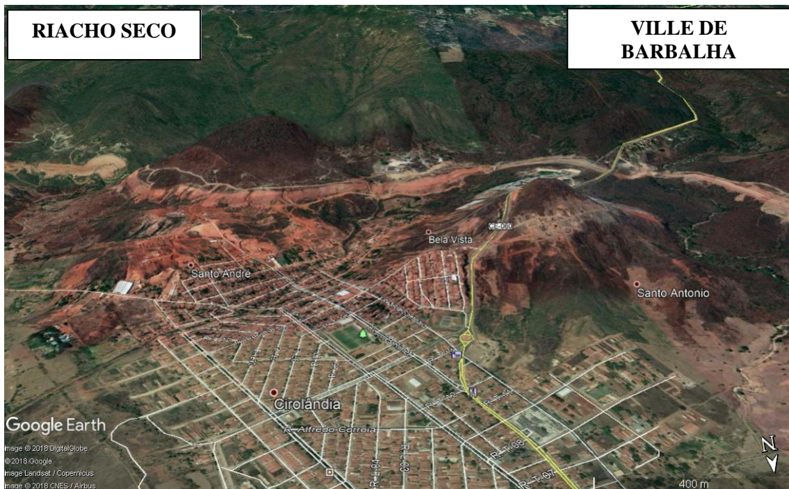
Figure 5.26. Les parties amont du bassin-versant du Riacho Seco, Barbalha. Image Google Earth, 2018. Le ravinement de la butte du quartier Santo André (voir aussi Fig. 5.7 C) et des remblais du canal de transposition, ainsi que l'aire imperméabilisée du carreau de la cimenterie IBACIP (à droite, près de la route et du canal)
