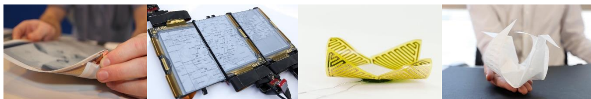
Figure 79 : Inspirations technologiques pour la Brochure du Maraudeur : a) PaperTab, un écran à encre électronique qui détecte les torsions. b) PaperFold, une interface composée d'écrans pliables. c) Unimorph, une interface à changement de forme contrôlée par la température. D) Aeromorph une structure en origami gonflable à changement de forme. (Sources : Human Media Lab, libre de droits et MIT Media Lab Tangible Media Group, CC BY-NC-ND 3.0).
