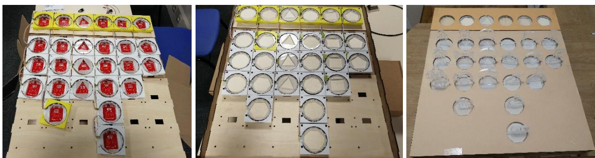
Figure 42 : Montage du plateau de MuseoTUI. Gauche) boîtiers contenant LED et RFID vissés dans le niveau inférieur. Milieu) Cales en medium et contre-formes placées dans les boîtiers. Droite) Niveau supérieur fixé sur le dessus des boîtiers, avec les figurines positionnées dans les contre-formes de la zone de stockage.
