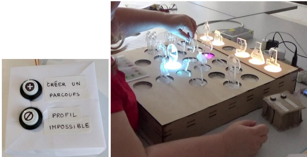
Figure 45 : Boutons de création de parcours et de déclaration d'un profil impossible. À droite le prototype complet pendant l'expérimentation, les boutons pouvaient être placés à droite ou à gauche selon le choix de l'utilisateur.
