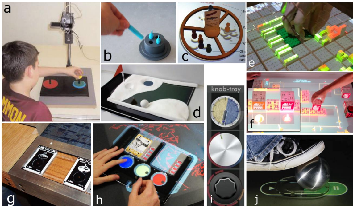
Figure 67 : Travaux technologiques et génériques T+C : a) une librairie pour créer des jeux mathématiques pour les enfants (Scarlato, 2006), b) ToyVision une toolkit pour prototyper des jeux sur table tactile (Marco, Cerezo et Baldassarri, 2012), c) TULIP une toolkit pour l'utilisation d'objets tangibles sur table tactile (Tobias, Maquil et Latour, 2015), d) GaussMarbles une bille magnétique pour des interactions sur tablette (Kuo et al. , 2016), e) Bits & Bricks, une matrice tangible interactive basée sur des LEGO™ et de la projection 3D (Winder et Larson, 2017), f) RFIbricks, un système d'assemblage de blocs basé sur le RFID (Hsieh et al. , 2018), g) Cartouche, des composants tangibles reprenant le principe de menu tangible (Ullmer et al. , 2010), h) Casier, des composants proposant plusieurs constraints à positionner sur des surfaces tactiles (Ullmer et al. , 2011), i) hard et soft tokens (de Siqueira et al. , 2018), j) Kickables, composants pour interagir avec les pieds (Schmidt et al. , 2014).
