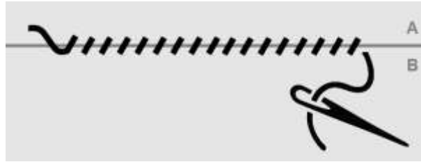
Fig. 123 : Point d'ourlet entre deux pièces de tissu A et B
