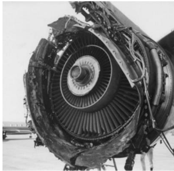
Figure 2 : Moteur d'avion suite à la rupture prématurée du disque fan en alliage de titane due à l'effet "dwell" (Freiherr von Thüngen, 2016).
