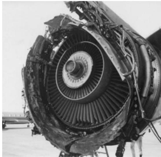
Figure 2 : Moteur d'avion suite à la rupture prématurée du disque fan en alliage de titane due à l'effet "dwell" (Freiherr von Thügen, 2016).
