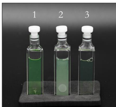
Figure 96 : Photographie des principaux échantillons de la condition SANS 2 après 45 minutes de mesure par TR-SANS à 55°C. (1) d-GFPssrA, (2) d-GFPssrA en présence de h-PAN, (3) d-GFPssrA en présence de h-PAN et de la particule h-20S. Les trois échantillons ont été préparés avec une concentration initiale de 100 mM ATP.
