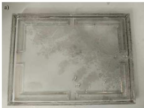
**Figure 6 :** Formation d'un film dans un contenant rectangulaire de faible profondeur obtenu par transfert d'une dispersion de chloroforme au centre du contenant.
