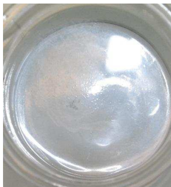
Figure 9 : Film de MWCNT continu obtenu en diminuant la surface accessible à volume de solution transférée et volume d'eau distillée constant.
