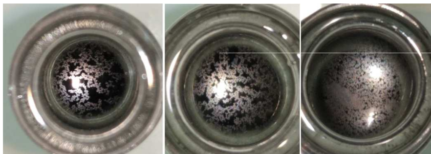
Figure 5 : Films formés à la surface de l'émulsion après intégration de différentes quantités d'acétone.
