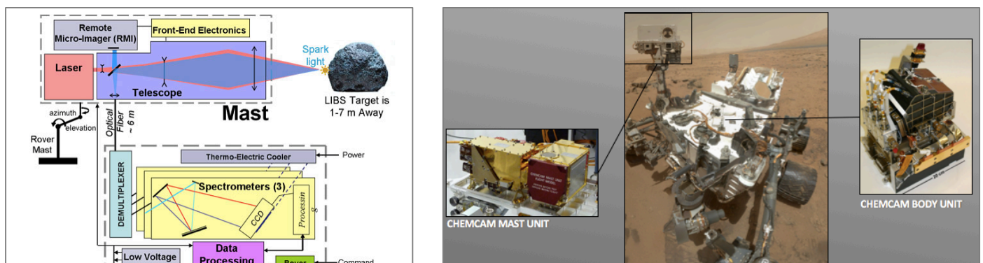
Figure 1: Diagramme structural de ChemCam (à gauche). Photo de Curiosity (à droite) (Credit: ChemCam/LANL/IRAP/CNES)
