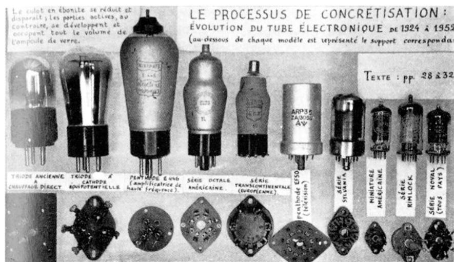
Figure 8 – Illustration du processus de concrétisation : évolution du tube électronique de 1924 à 1952.
