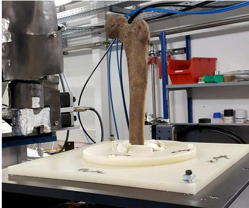
Figure 27 : Exemple d'un fémur humain en place dans la platine de rotation de la ligne PSICHE.
