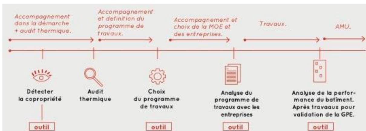
Figure 40 : Schéma du process de la rénovation d’une copropriété
