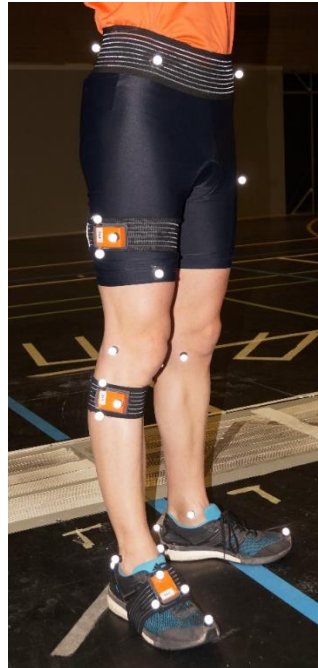
Figure 34 : Sujet équipé avec les centrales inertielles et les marqueurs réfléchissants.
