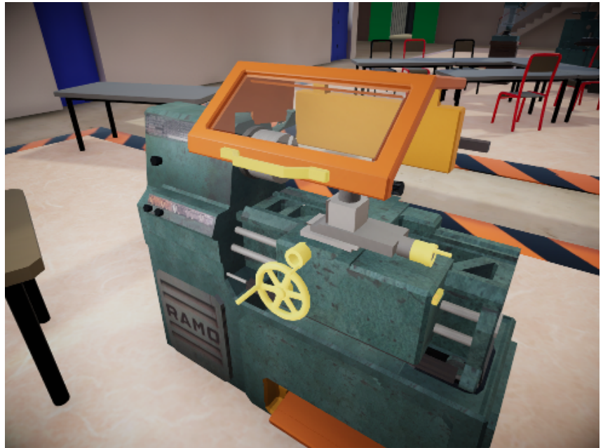
FIGURE 4.1 – Capacités interactionnelles du tour conventionnel de Meca3D. En jaune, les objets ou éléments avec lesquels l'utilisateur peut interagir.
