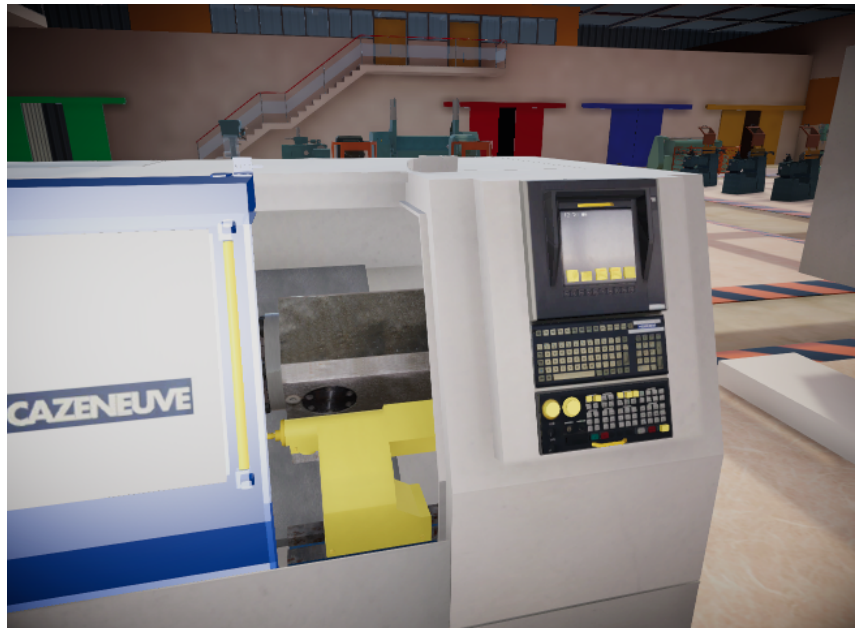
FIGURE 4.2 – Capacités interactionnelles du tour à commande numérique de Meca3D. En jaune, les objets ou éléments avec lesquels l'utilisateur peut interagir (trois vis présentes sur la poupée mobile supportant la contre-pointe sont utilisables mais non visibles, la poupée étant elle-même un objet avec lequel il est possible d'interagir).
