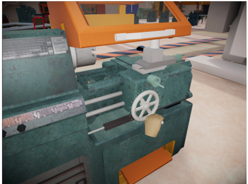
FIGURE 4.6 – Rotation de la manivelle du tour conventionnel à l'aide d'une poignée. Seule la position de la main virtuelle est utilisée pour cette opération.
