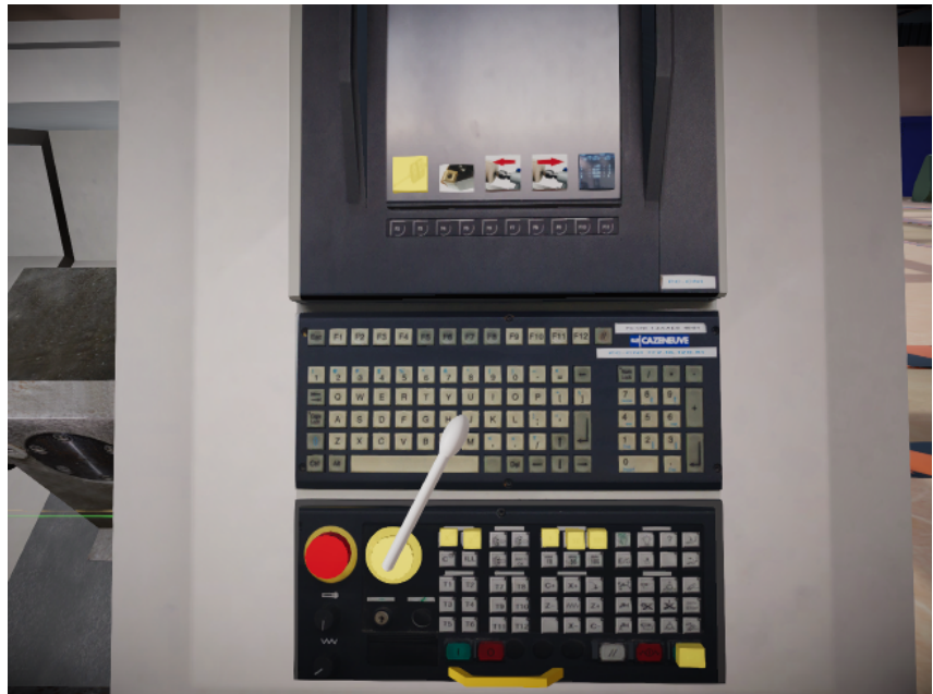
FIGURE 4.8 – Le bouton rotatif du panneau de contrôle possède la même affordance que les vis
