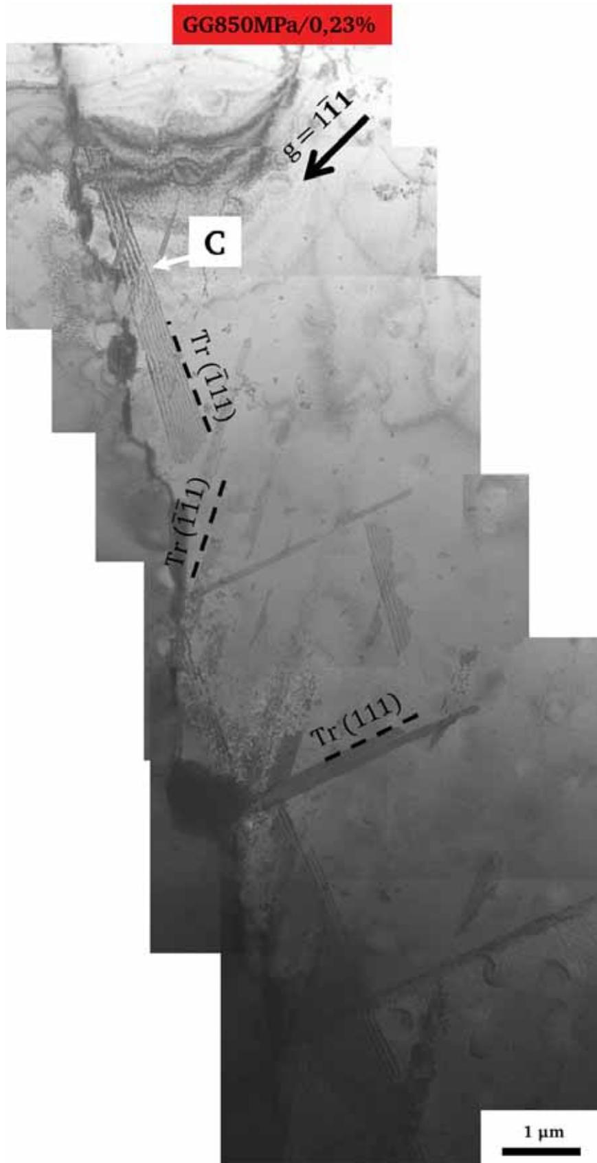
Figure III-40 : Paysage de déformation au voisinage d'un deuxième joint de grains présent dans un échantillon flué à 700°C sous 850 MPa jusqu'à environ 0,2% de déformation – grain à **droite** du joint.
