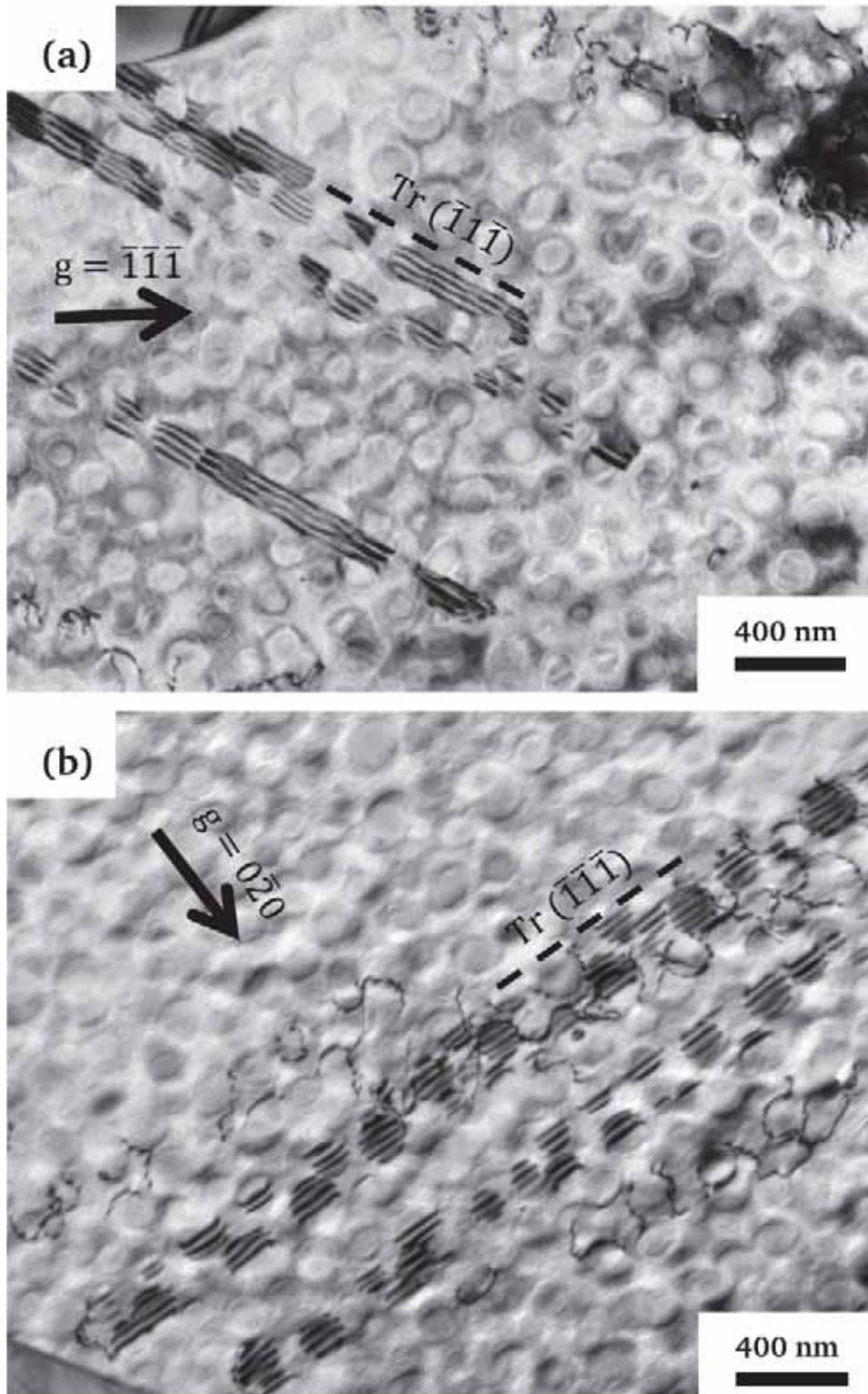
Figure IV-36 : Images MET présentant le cisaillement de la matrice et des précipités par des dislocations partielles (a) et le mécanisme de Condat et Decamps (b) dans les échantillons vieillis 100 h à 850°C.
