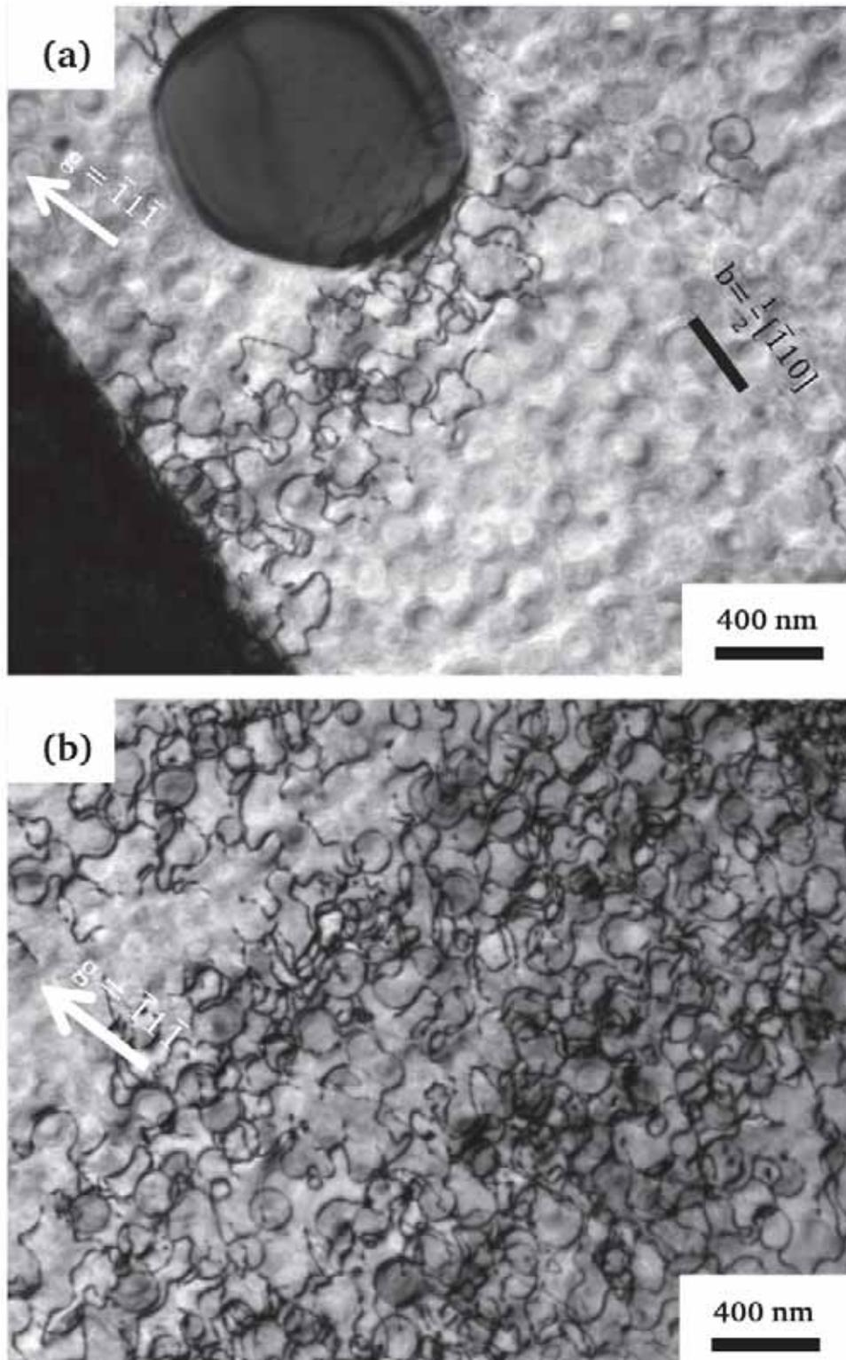
Figure IV-35 : Images MET présentant les micromécanismes impliquant des dislocations parfaites dans les échantillons vieillis 100 h à 850°C.
