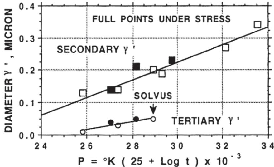
Figure I-9 : Variation de la taille des précipités  $\gamma'$  secondaires et tertiaires en fonction du paramètre  $P$  qui tient compte de la durée et de la température de vieillissement dans le René88 [Wlodek, 1996].
