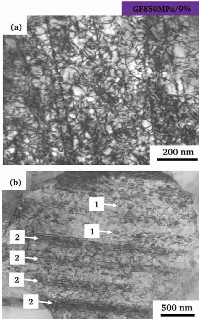
Figure III-24 : Paysage de déformation dans le grain d'un échantillon flué sous 850 MPa jusqu'à la rupture (9% de déformation).
