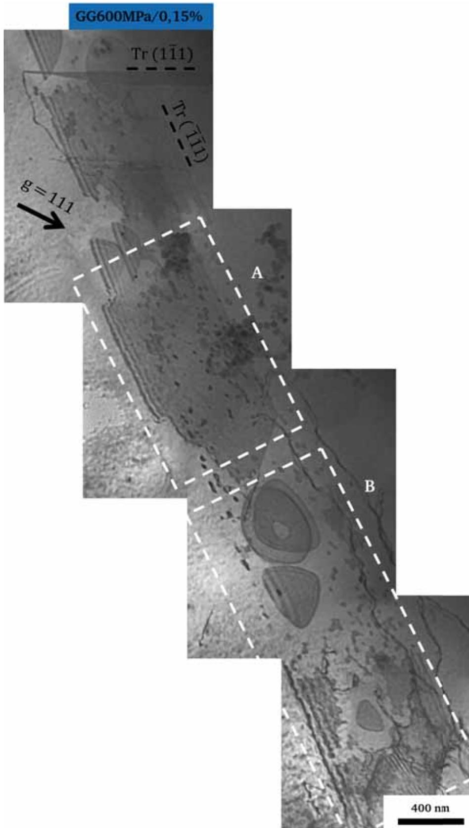
Figure III-28 : Micromécanismes de déformation aux cœurs des grains d'échantillons flués sous 600 MPa- cisaillement des précipités  $\gamma'$  par des dislocations partielles.
