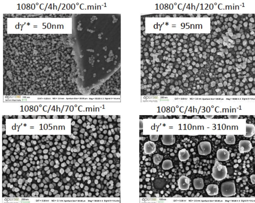
Figure I-39 : Observations au MEB-FEG de l'effet de la vitesse de refroidissement sur la microstructure de précipitation de l'AD730™ [Devaux, 2012].
