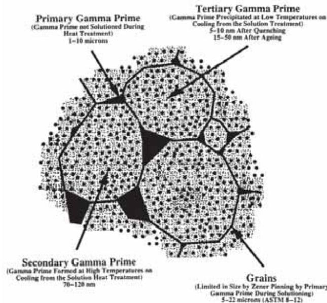
Figure I-4 : Schéma représentant les trois types de précipités  $\gamma'$  dans un superalliage polycristallin [Jackson, 1999].
