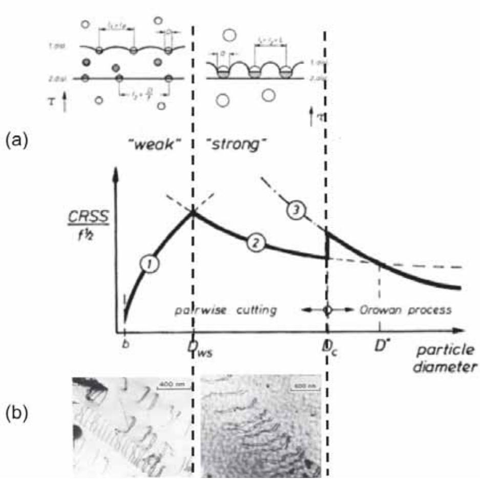
Figure I-31 : Évolution des mécanismes de franchissement en fonction de la taille des précipités  $\gamma'$  (a) représentation schématique [Hüther, 1978] (b) observations MET dans le Nimonic PE 16 [Reppich, 1982].
