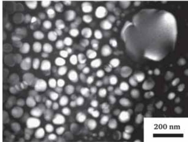
Figure II-3 : Image MET de la microstructure de précipitation observée en champ sombre de l'AD730™.
