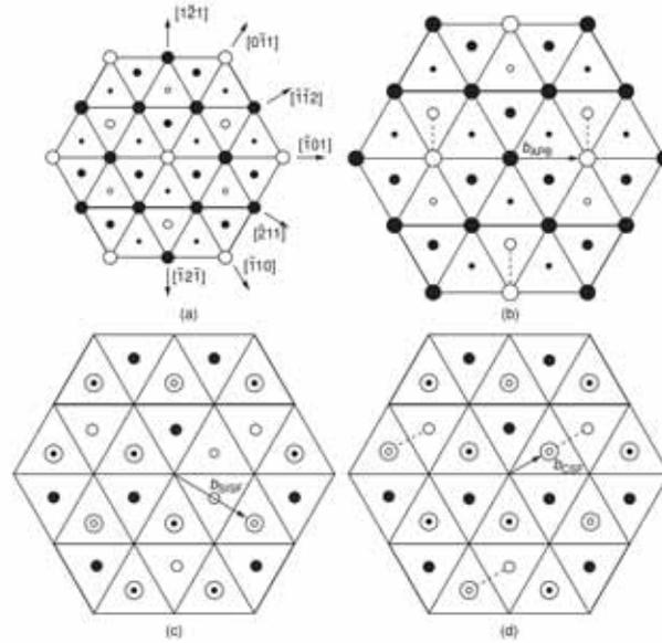
Figure I-21 : Représentation des défauts plans dans la structure  $L1_2$ , (a) structure non cisailée (b) couche supérieure cisailée par  $a/2 \langle \bar{1}01 \rangle$  pour former une paroi d'antiphase (c) cisailée par  $a/3 \langle \bar{2}11 \rangle$  pour former un défaut intrinsèque (SISF), (d) cisailée par  $\frac{a}{6} \langle \bar{1}\bar{1}2 \rangle$  pour former une faute complexe [Pope, 1984].
