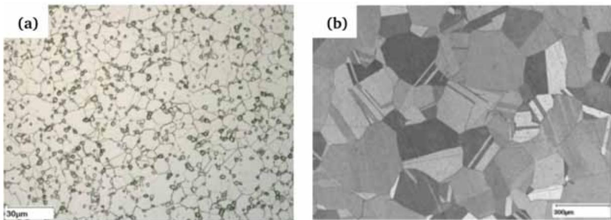
Figure I-35 : Structure granulaire de la version (a) grain fin et (b) gros grain de l'AD730<sup>TM</sup> [Devaux, 2014].
