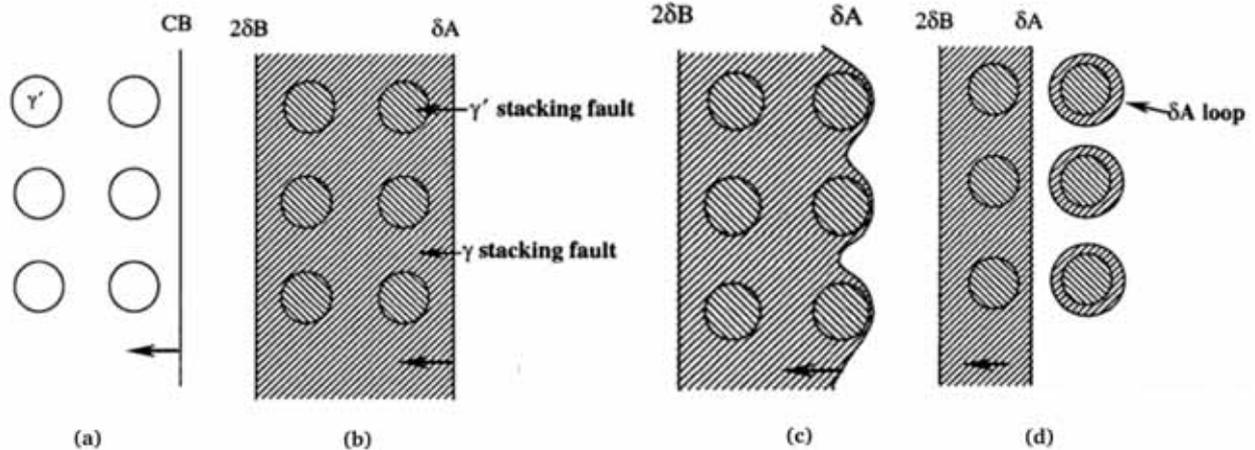
Figure I-23 : Mécanisme de création de fautes de super-réseau dans la matrice et les précipités  $\gamma'$  [Zhang, 2001].
