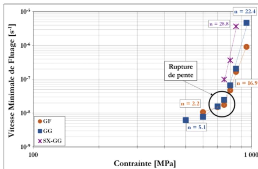
Figure I-38 : Diagramme de Norton de l'AD730<sup>TM</sup> des essais de fluage à 700°C [Thébaud, 2017].
