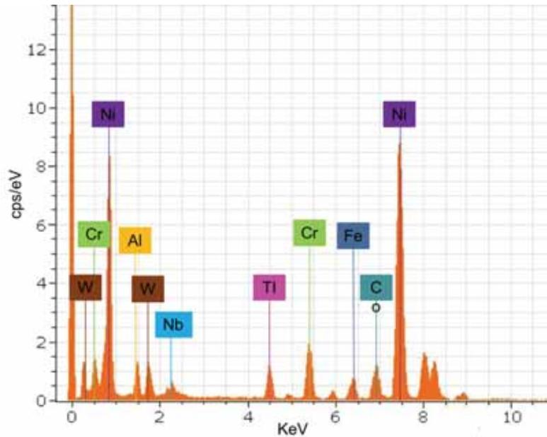
Figure II-10 : Exemple de spectre EDX de l'AD730<sup>TM</sup>.
