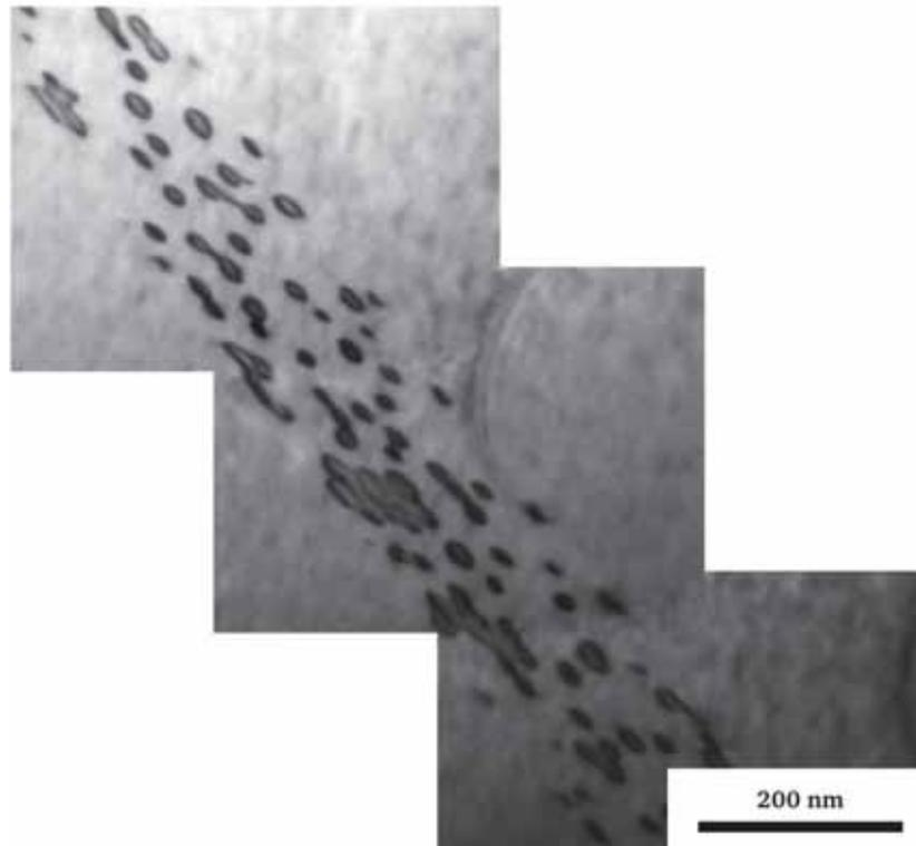
Figure II-7 : Image MET en champ clair de précipités  $\gamma'$  tertiaires cisailés selon le mécanisme de Condat et Decamps.
