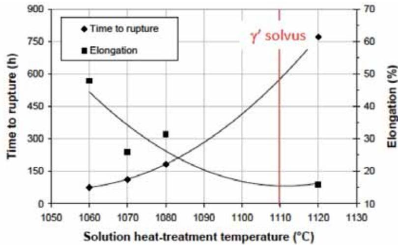
Figure I-36 : Effet de la température de mise en solution sur les propriétés mécaniques en fluage à 750°C – 450 MPa dans l'AD730<sup>TM</sup> [Devaux, 2012].
