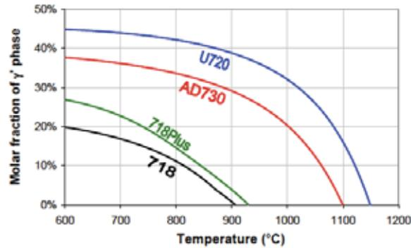
Figure I-34 : Fraction molaire de  $\gamma'$  en fonction de la température de l'AD730<sup>TM</sup> et de ses concurrents déterminés par thermo-calc [Devaux, 2016].
