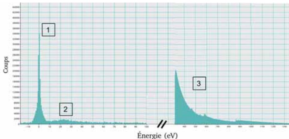
Figure II-11 : Spectre EELS extrait du spectre image de l'AD730<sup>TM</sup>.
