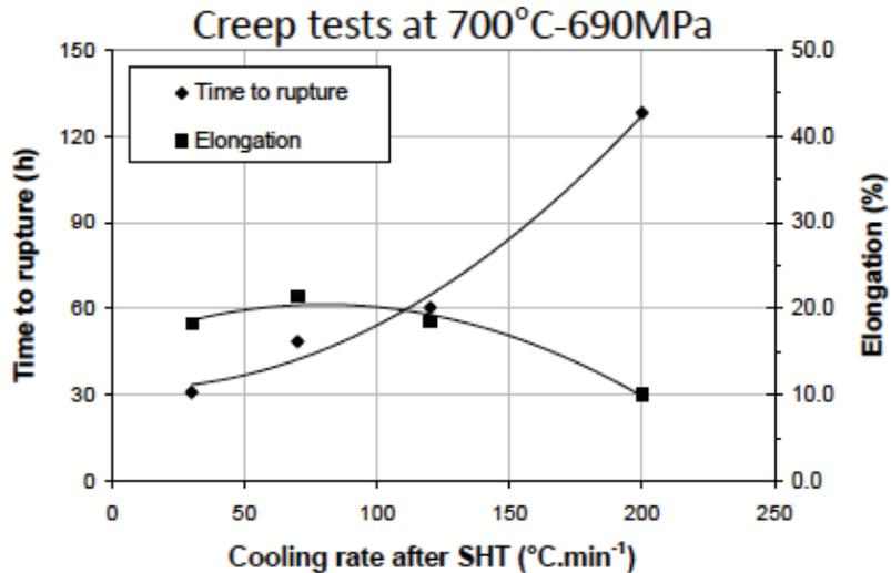
Figure I-40 : Effet de la vitesse de refroidissement sur les propriétés mécaniques en fluage à 700°C – 690 MPa dans l'AD730<sup>TM</sup> [Devaux, 2012].
