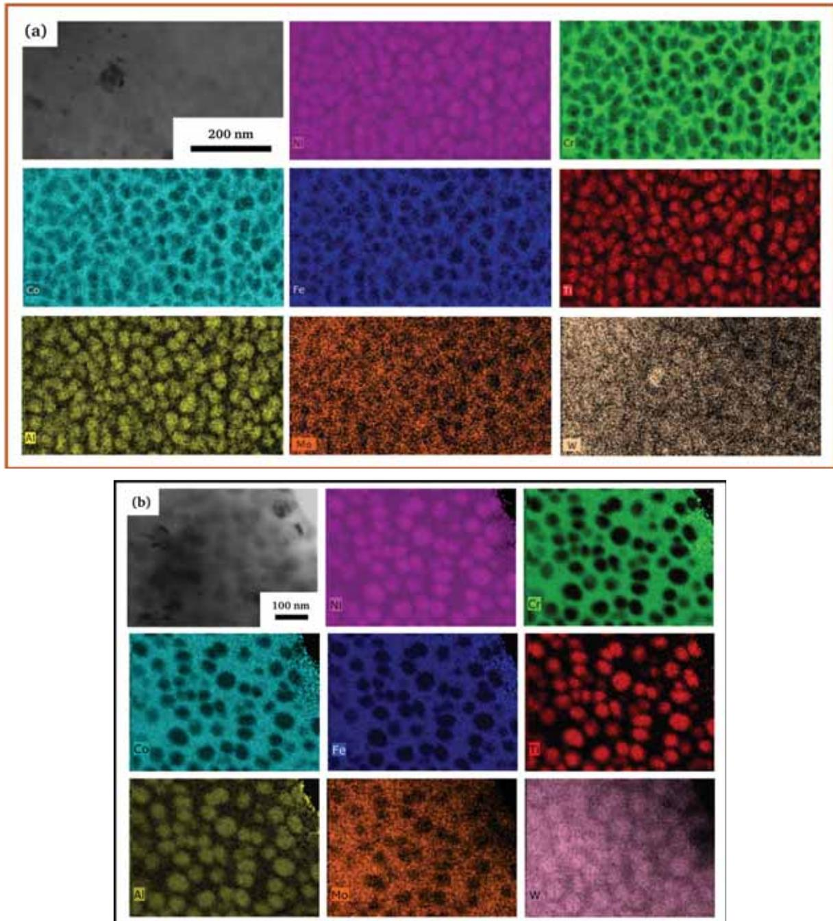
Figure IV-9 : Cartographies obtenues par spectroscopie EDX illustrant la répartition des éléments entre la matrice  $\gamma$  et les précipités  $\gamma'$  dans les échantillons GF760°C (a) et GF790°C (b).
