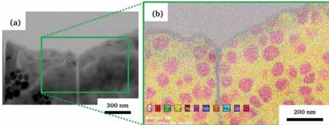
Figure II-9 : Cartographie EDX de l'AD730<sup>TM</sup> montrant les différents éléments présents dans l'alliage.
