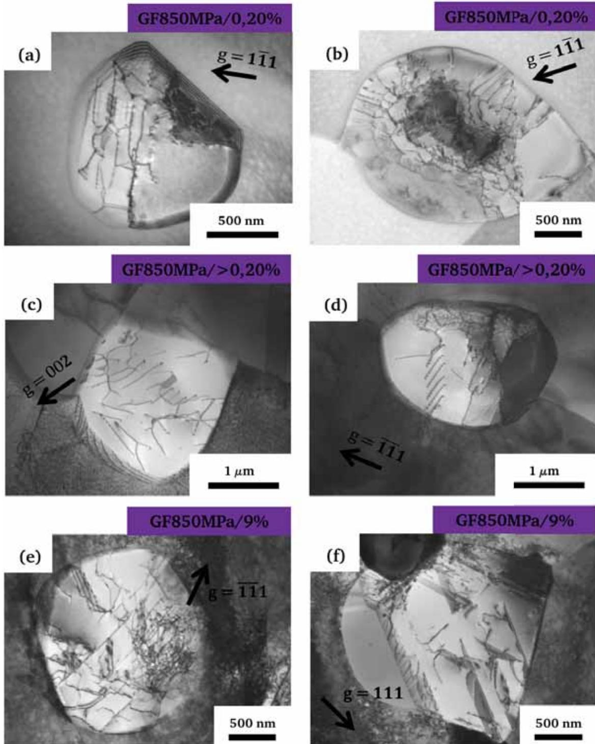
Figure III-19 : Images MET en champ clair de précipités primaires déformés dans des échantillons flués sous 850 MPa.
