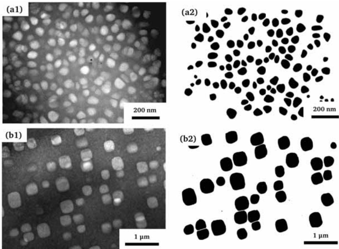
Figure II-6 : Méthode de mesure de la taille des précipités  $\gamma'$  secondaires a1 et b1) micrographie de la microstructure en champ clair (a2 et b2) précipités  $\gamma'$  sélectionnés dans les échantillons à microstructure (a) GF (b) GG.
