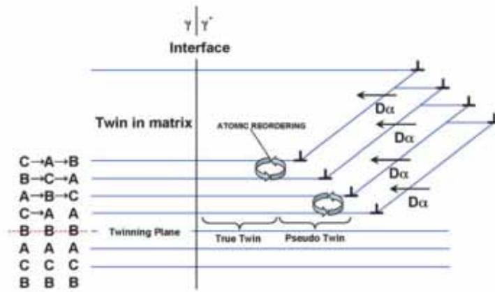
Figure I-27 : Schématisation du micromaclage dans la matrice et les précipités  $\gamma'$  via la réorganisation atomique d'après [Unocic, 2008].
