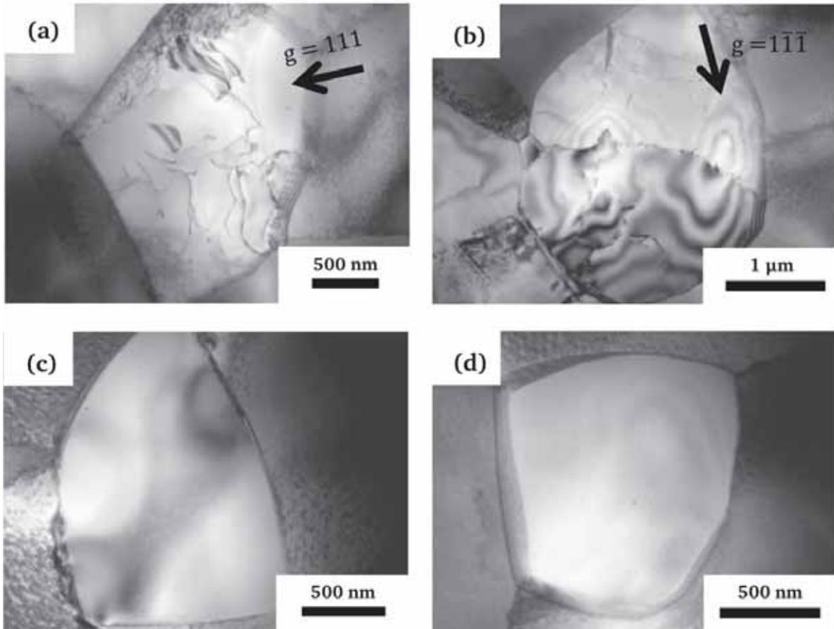
Figure IV-29 : Images MET de précipités  $\gamma'$  primaires dans des échantillons non vieillis (a et b) précipités  $\gamma'$  primaires déformés (c et d) précipités  $\gamma'$  primaires non déformés.
