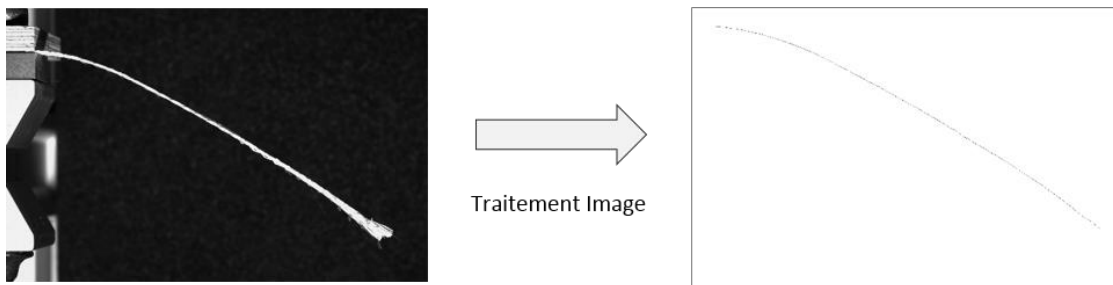
Figure 2-32: Extraction de la ligne moyenne par méthode optique
