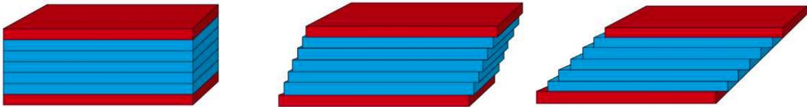
Figure 57 : Modèle plan-plan pour les mesures de rhéologie : le cisaillement est appliqué à l'échantillon qui est entre les deux plateaux, lorsque celui du haut est en mouvement. Le plateau du bas reste fixe. Les figures représentent une illustration des couches planes du fluide, qui se déplacent les unes par rapport aux autres<sup>310</sup>.
