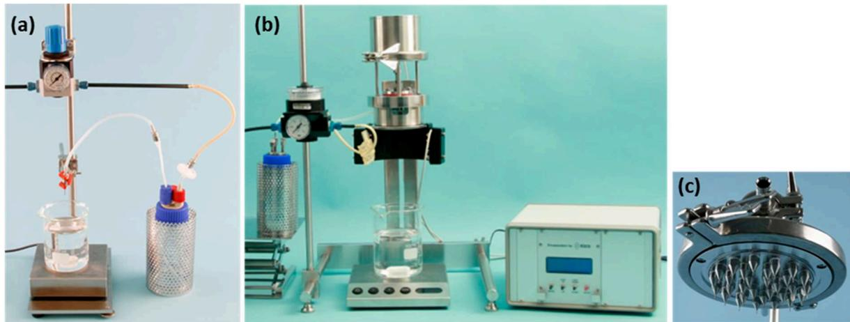
Figure 10 : Dripping en goutte à goutte par gravité (Nisco©) - (a) Système à aiguille simple; (b) Système à plusieurs aiguilles; (c) Tête de 30 aiguilles
