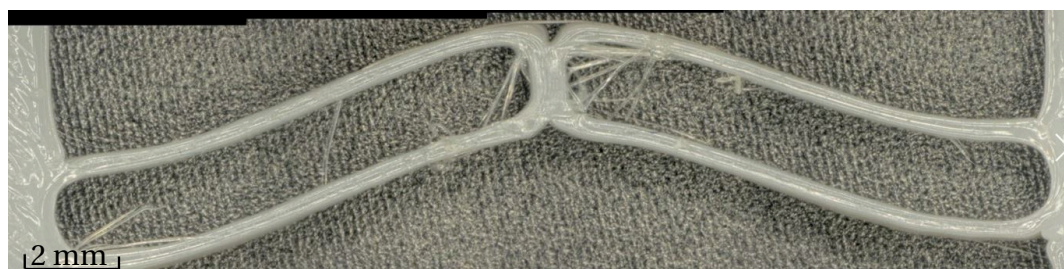
FIGURE 3.19. Zoom \times 50 du mécanisme bistable miniature.
