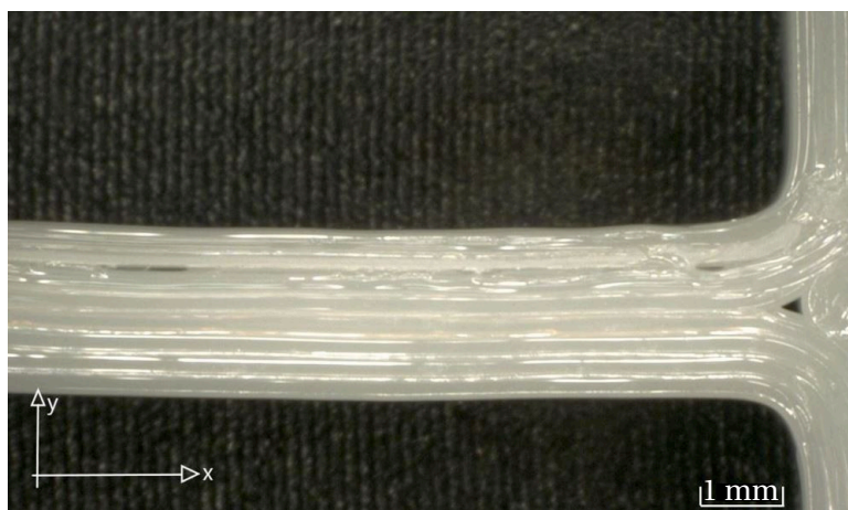
FIGURE 3.17. Zoom \times 30 de la lame du mécanisme bistable large.
