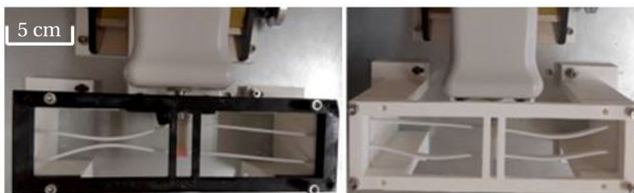
FIGURE 3.29. Comportements inattendus du mécanisme bistable allant de sa première position stable à la seconde.
