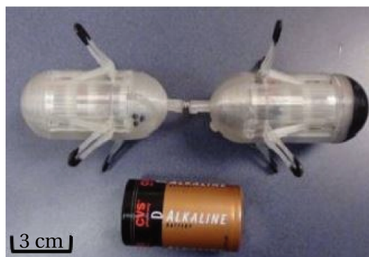
FIGURE 1.8. Capsule endoscopique composée de deux robots fabriquée par impression 3D [7].
