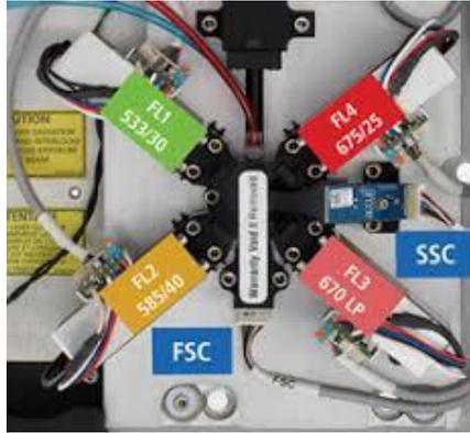
Figure 139 : Photographie des différents filtres et détecteurs du cytomètre en flux BD Accuri C6.
