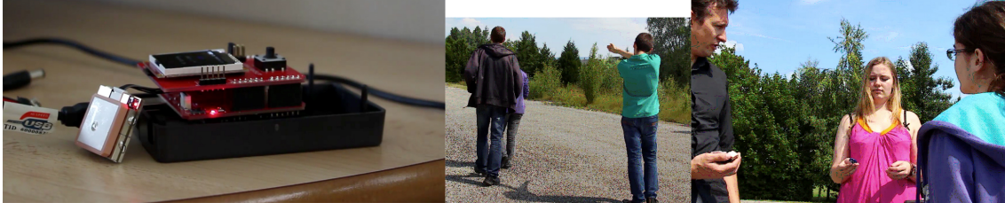
Figure 4.9 – Configuration d'un capteur GPS avec un écran LCD alimenté par une pile 9V et utilisé pour résoudre une quête du jeu.
