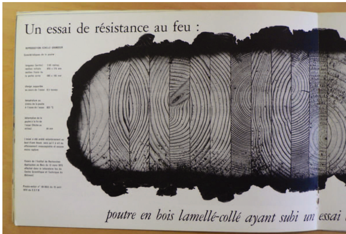
Illustration n° 103 : « Un essai de résistance au feu », Syndicat National du Bois Lamellé Collé, La Charpente en Bois Lamellé-collé , Dourdan, H. Vial, 1973. Archives Syndicat du Lamellé Collé.
