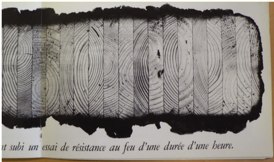
Illustration n° 104 : « Un essai de résistance au feu », Syndicat National du Bois Lamellé Collé, La Charpente en Bois Lamellé-collé , Dourdan, H. Vial, 1973. Archives Syndicat du Lamellé Collé.
