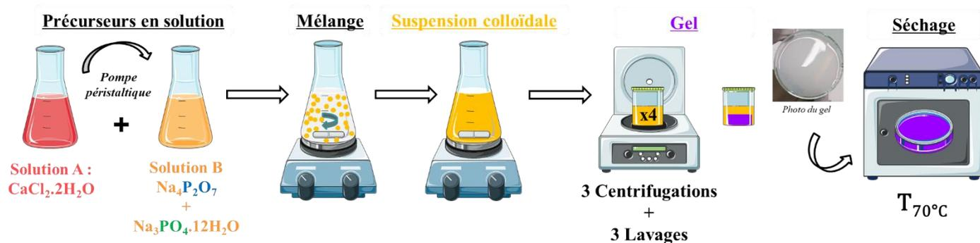
**Figure II - 5 : Schéma des étapes du protocole de synthèse des matériaux NaPYG-0X0**
