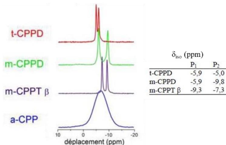
Figure IV - 8 : Spectres RMN-MAS  $^{31}\text{P}$  et déplacements chimiques (ppm) des composés cristallisés de pyrophosphates de calcium hydratés : m-CPPD, t-CPPD, m-CPPT  $\beta$  et a-CPP (Gras, 2014).
