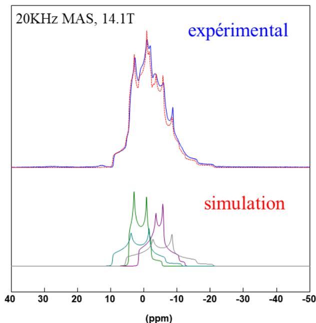
Figure II - 4 : Spectre RMN du solide du  $^{23}\text{Na}$  pour le précurseur  $\text{Na}_4\text{P}_2\text{O}_7$
