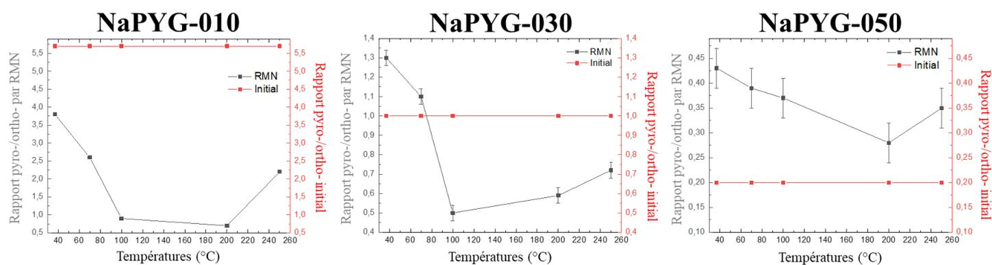
**Figure III - 5 : Evolution du rapport pyro-/orthophosphate déterminé à partir des données de RMN en phase solide comparé au rapport initial pour les matériaux NaPYG-010, -030 et -050 élaborés à différentes températures de séchage**
