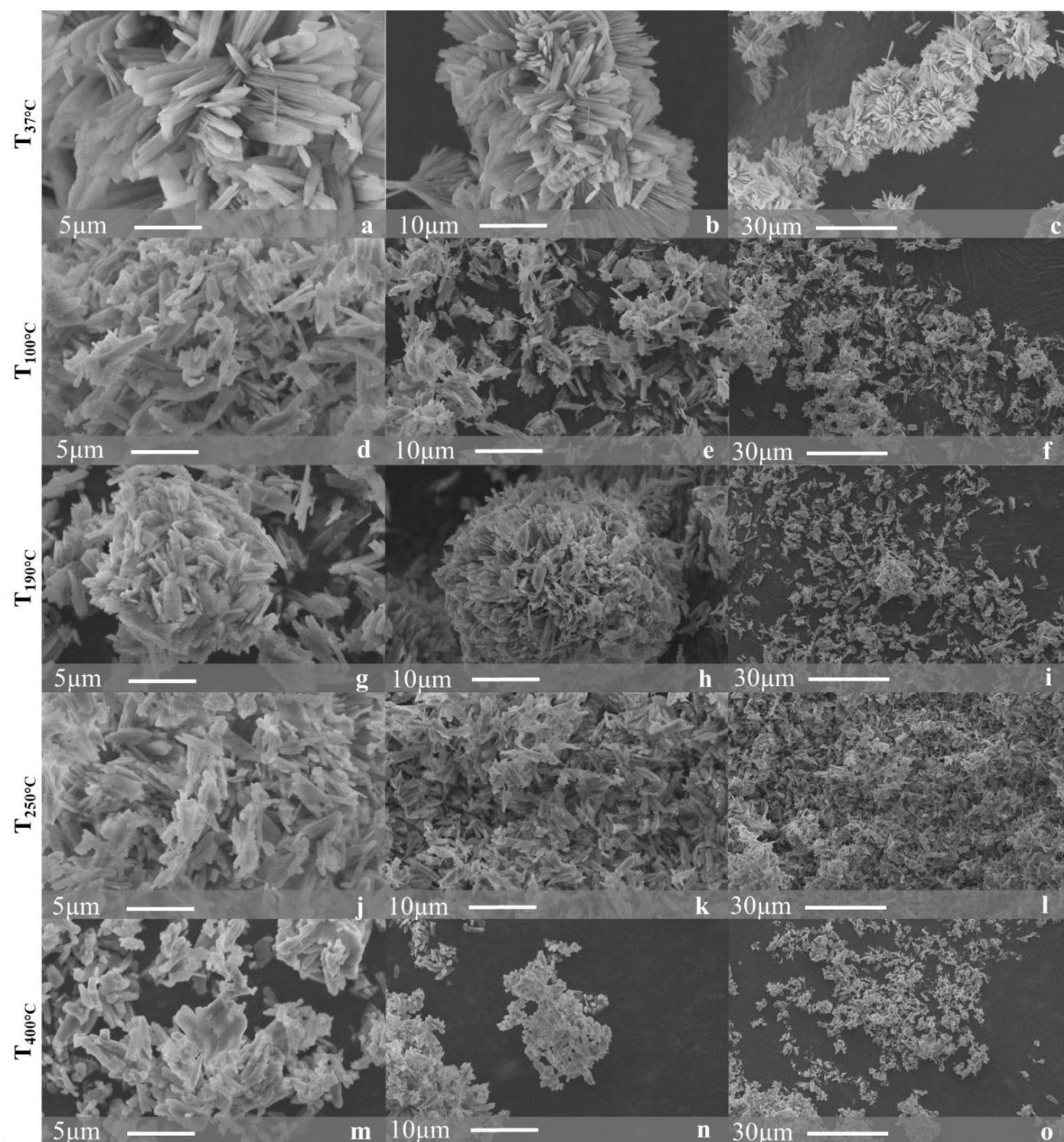
**Figure IV - 13 : Micrographies MEB montrant l'évolution de la morphologie du pyrophosphate de calcium et sodium tétrahydraté synthétisée et séchée à différentes températures.**
