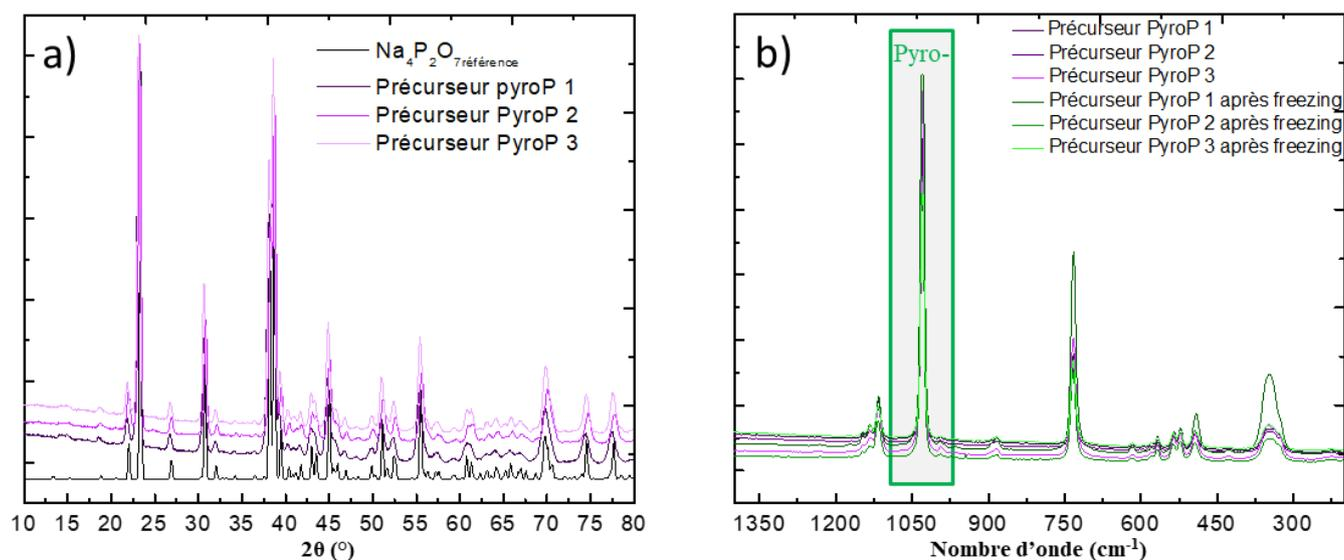
**Figure II - 2 : a) : Diffractogrammes de rayons-X (anticathode Cobalt :  $\lambda(K\alpha) = 1,788970 \text{ \AA}$ ) et b) Spectres Raman (normalisés) de précurseurs pyrophosphate de sodium synthétisés au laboratoire. Vérification entre différents lots (reproductibilité, Fig. a et b) ainsi qu'avant et après conservation au congélateur à  $-20^\circ\text{C}$  (trois lots différents, Fig. b).**
