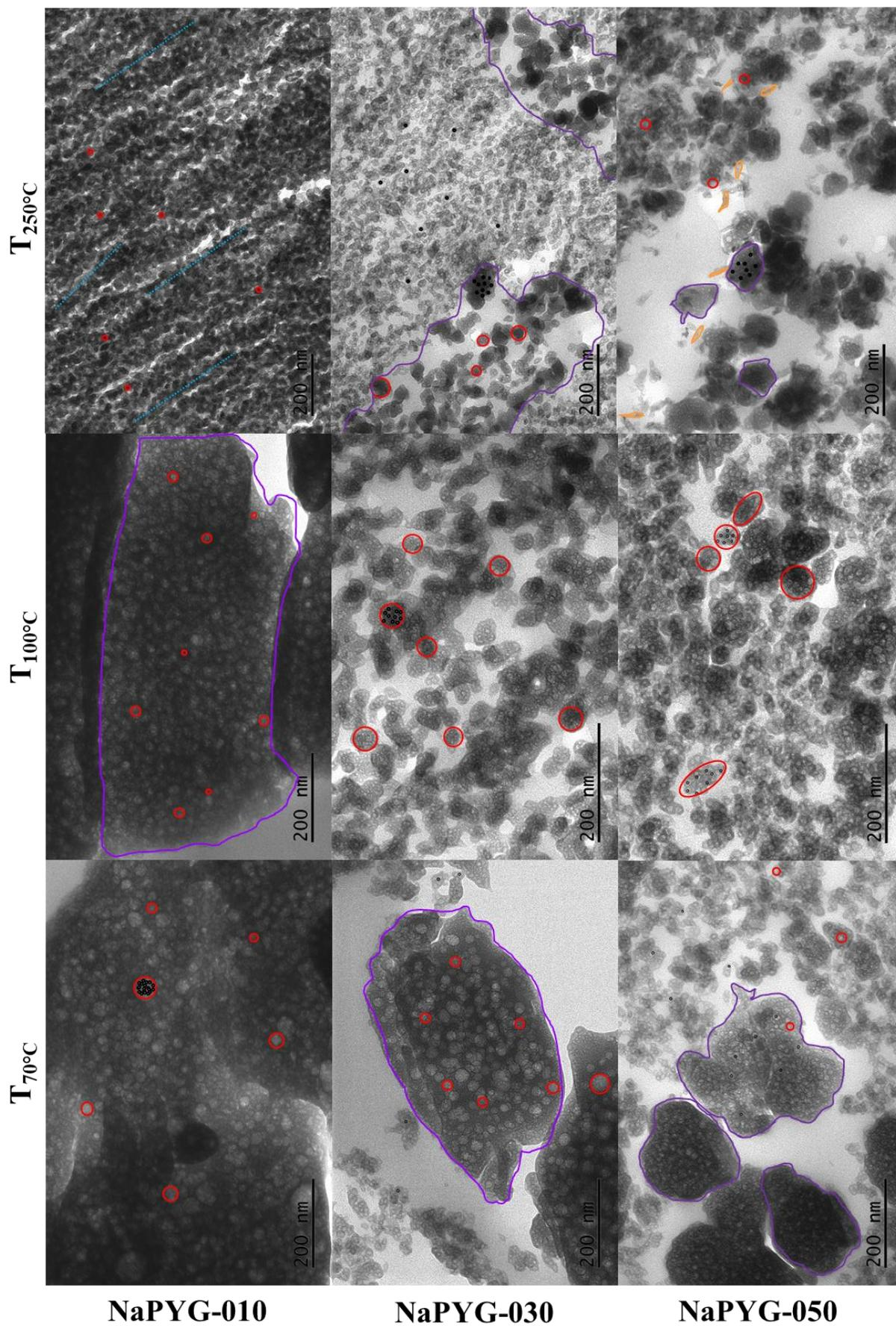
Figure III - 7 : Clichés MET des trois compositions de matériaux NaPYG-010, -030 et -050 élaborés à la température de référence (T<sub>70°C</sub>) et à deux autres températures de séchage plus élevées (T<sub>100°C</sub> et T<sub>250°C</sub>)
