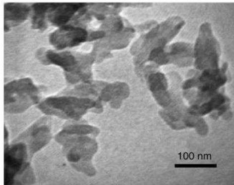
Figure III - 9 : Image MET de nanocristaux d'apatite nanocristalline (Drouet, 2009)
