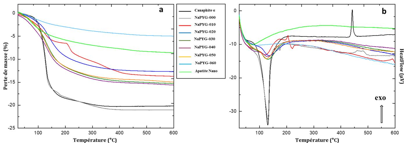
**Figure II - 12 : Courbes ATG (à gauche) et ATD (à droite) des matériaux NaPYG-0X0 élaborés**
