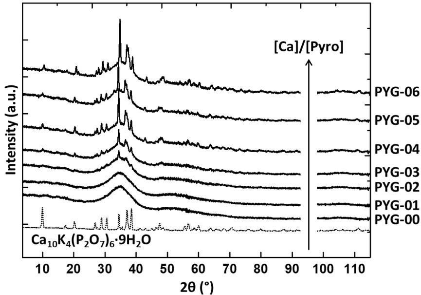
Figure I - 10 : Diagrammes de DRX des matériaux PYG-0X élaborés à partir d'un rapport Ca/Pyro initial en solution de 0,2 à 0,9 et comparé à celui du composé de référence cristallisé  $\text{Ca}_{10}\text{K}_4(\text{P}_2\text{O}_7)_6 \cdot 9\text{H}_2\text{O}$  (Soulié, 2016b)
