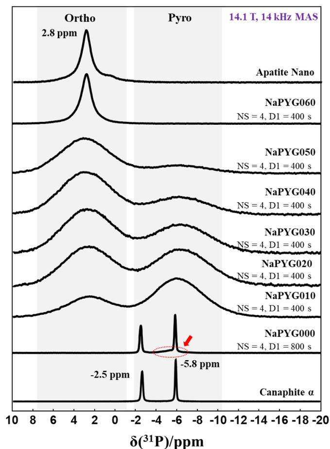
Figure II - 10 : Spectres RMN du solide  $^{31}\text{P}$  MAS SPE pour les différentes compositions de matériaux NaPYG-0X0 synthétisés
