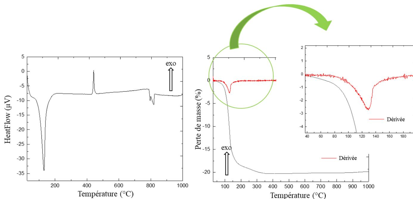
Figure IV - 9 : Courbes ATD (à gauche) et ATG (à droite) de la canaphite  $\alpha$  synthétisée
