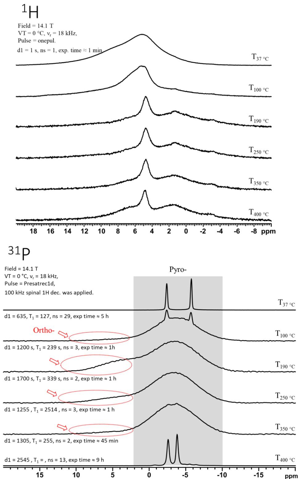
**Figure IV - 15 : Spectres RMN en phase solide  $^1\text{H}$  (en haut) et  $^{31}\text{P}$  (en bas) des matériaux élaborés dans les condition de la canaphite  $\alpha$  mais séchés à différentes températures**
