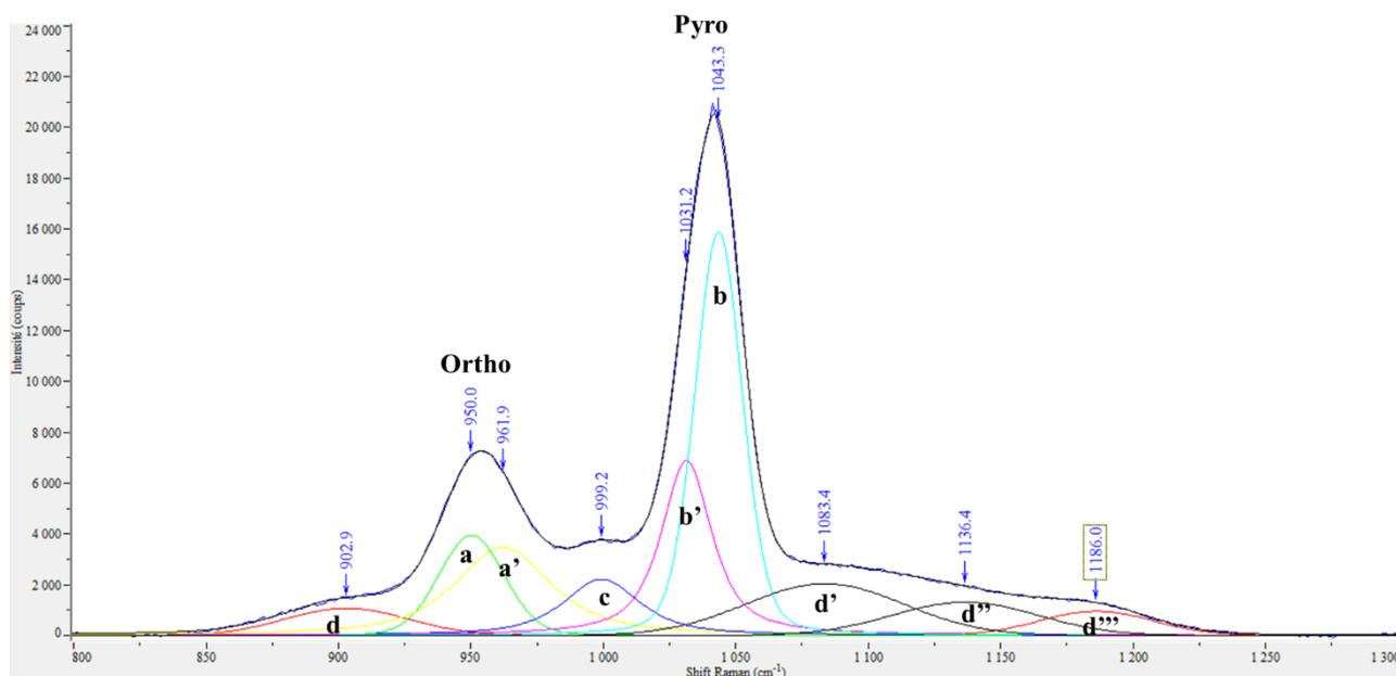
**Figure II - 9 : Exemple de décomposition du spectre Raman dans le domaine  $800\text{-}1300\text{ cm}^{-1}$  du matériau NaPYG-010 : les différents pics issus de la décomposition sont notés a, a', b, b', c, d, d', d'' et d'''', les paramètres de décompositions sont décrits dans l'annexe A2.1**
