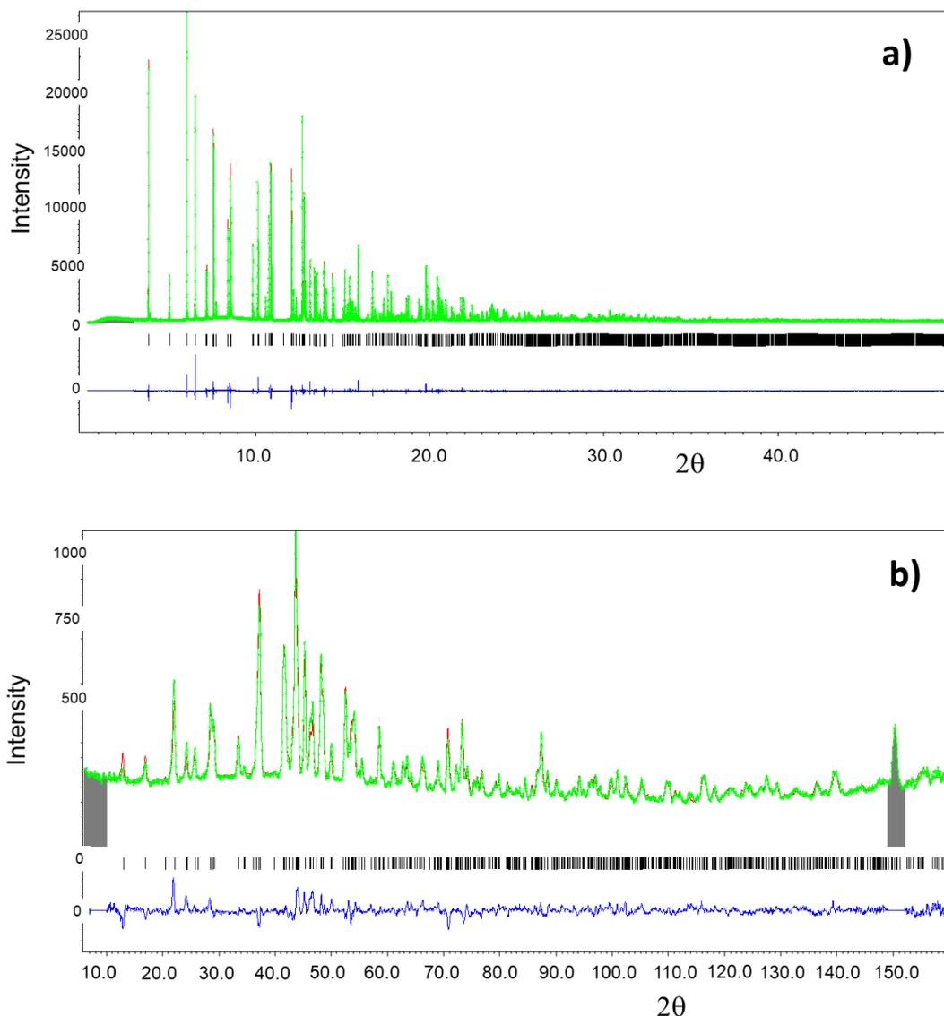
**Figure IV - 10 : Diffractogramme de RX obtenue sur la ligne Cristal du synchrotron Soleil et affinement Rietveld (a) et diffractogramme neutrons obtenu au LLB et affinement Rietveld (b) pour la canaphite  $\alpha$  synthétisée (non deutérée (a) et deutérée (b)).**
