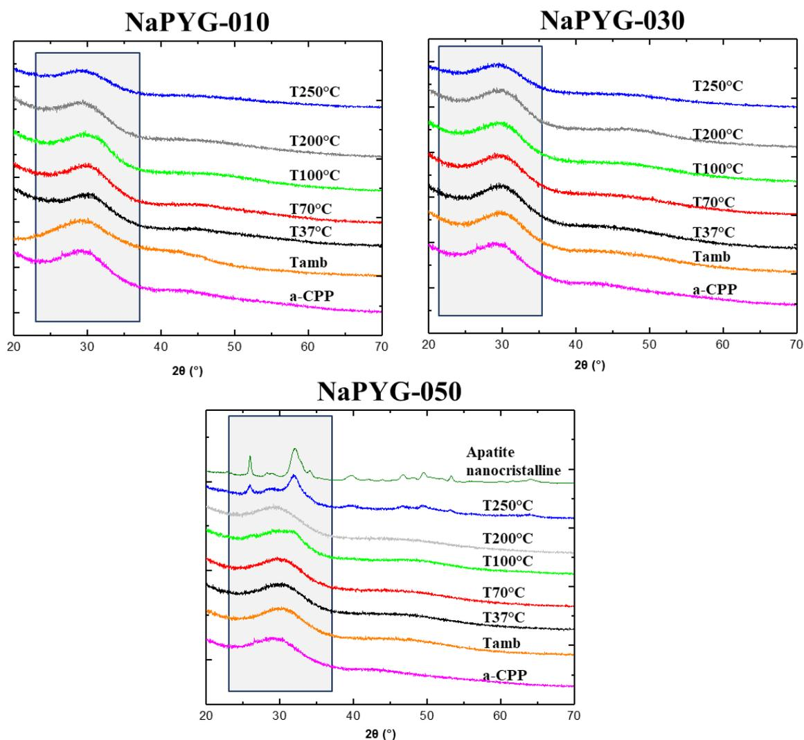
**Figure III - 2 : Diffractogrammes de rayons-X (anticathode en cuivre ( $\lambda(K_{a1}) = 1,54056 \text{ \AA}$ ,  $\lambda(K_{a2}) = 1,54433 \text{ \AA}$ )) des matériaux NaPYG-010, NaPYG-030 et NaPYG-050 élaborés à différentes températures de séchage et comparés à un composé pyrophosphate de calcium amorphe de référence synthétisé au CIRIMAT (a-CPP).**
