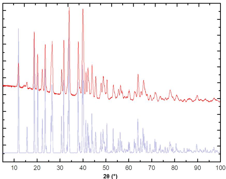
Figure IV - 3 : Diffractogramme RX de la canaphite  $\alpha$  synthétisée (acquisition anticathode Cobalt :  $\lambda(\text{K}\alpha) = 1,788970 \text{ \AA}$ ) (en rouge) comparé à celui d'un monocristal de canaphite  $\alpha$  synthétique correspondant à la fiche ICSD n° 26015 (en bleu) (Cheng, 1980)
