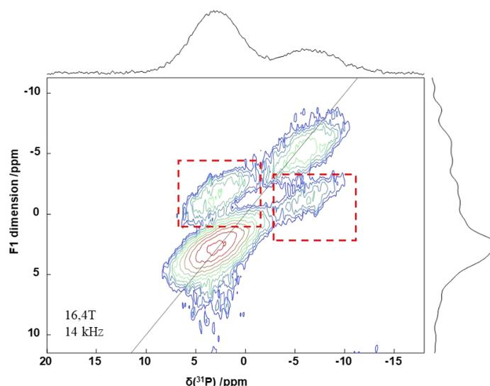
**Figure II - 17 : Spectre  $^{31}\text{P}$  SQ-DQ du matériau NaPYG-030  $T_{70^\circ\text{C}}$  enregistré à 16,4T, à une rotation de 14 kHz. Les carrés pointillés rouges représentent les pics croisés entre les ions ortho- et pyrophosphates (les paramètres d'acquisition des expériences RMN en phase solide sont détaillés dans l'annexe A8.)**
