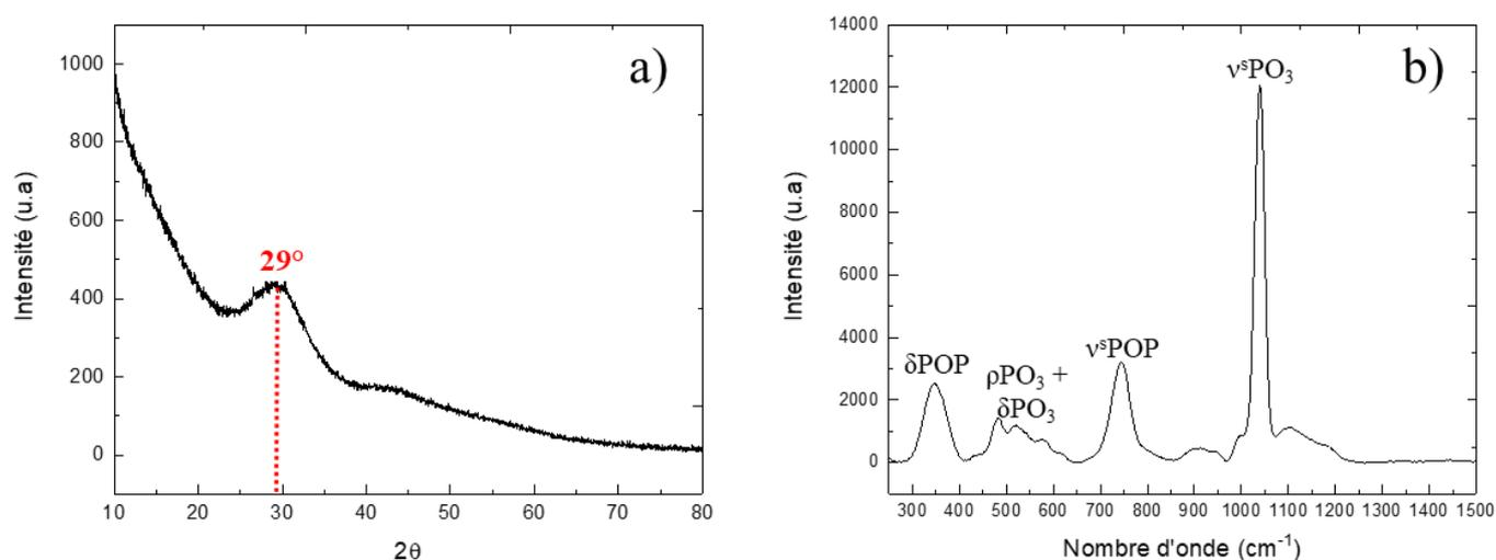
Figure I - 7 : Analyses par a) DRX et b) spectroscopie Raman de l'aCPP synthétisé au CIRIMAT (Gras, 2014)
