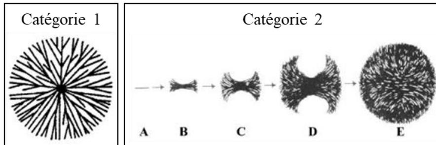
Figure IV - 5 : Schéma de la formation de sphérulites de catégorie 1 (à gauche) et 2 (à droite) (Gránásy, 2005)
