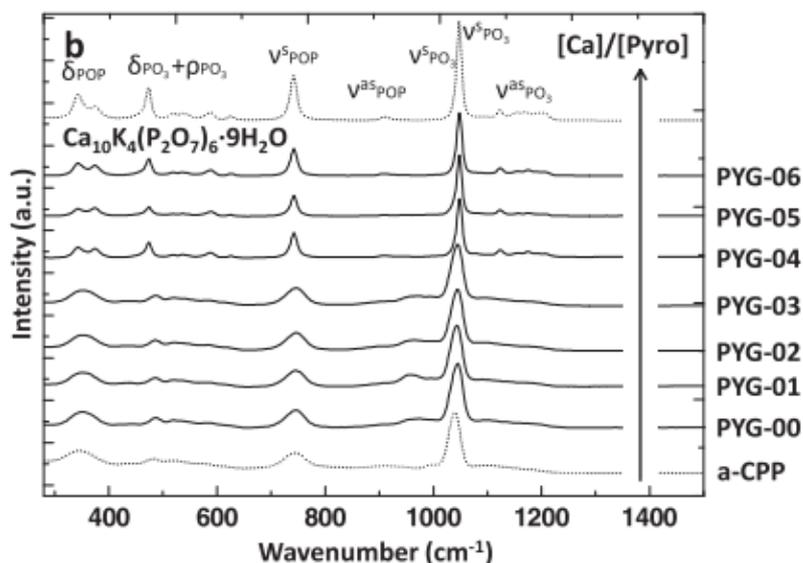
Figure I - 11 : Spectres RAMAN des matériaux PYG-0X élaborés à partir d'un rapport Ca/Pyro initial en solution différent de 0,2 à 0,9 et comparé à celui de deux composés de référence : a-CPP et  $\text{Ca}_{10}\text{K}_4(\text{P}_2\text{O}_7)_6 \cdot 9\text{H}_2\text{O}$  (Soulié, 2016b)
