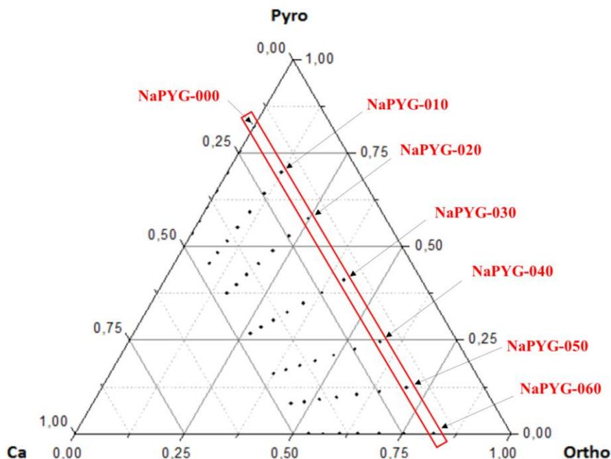
**Figure II - 1 : Diagramme ternaire des précurseurs ioniques en solution (% molaires des ions orthophosphate, pyrophosphate et calcium) lors de la synthèse des matériaux NaPYG-0X0. Les compositions initiales qui seront étudiées sont représentées par les sept points noirs encadrés en rouge sur ce diagramme.**
