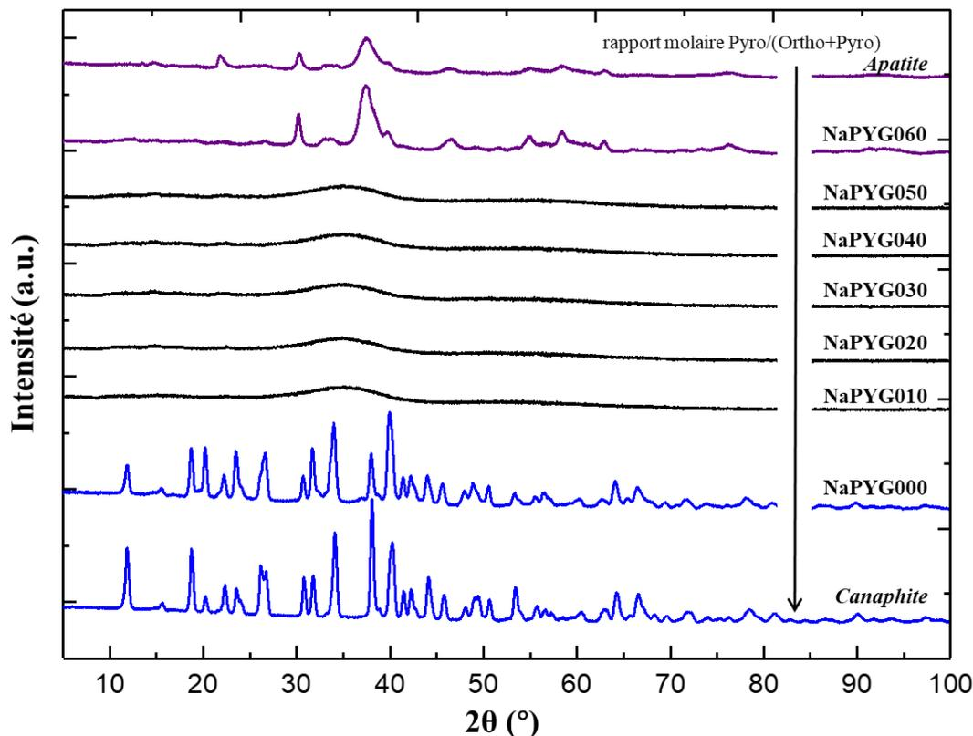
**Figure II - 7 : Diffractogrammes de rayons-X (anticathode Cobalt :  $\lambda(K\alpha) = 1,788970 \text{ \AA}$ ) pour les matériaux NaPYG-0X0 élaborés à partir à différents rapports molaire Pyro/(Ortho+Pyro) initiaux en solution comparés à ceux de composés synthétiques de référence : une apatite nanocristalline et la canaphite  $\alpha$  toutes deux synthétisées au laboratoire.**
