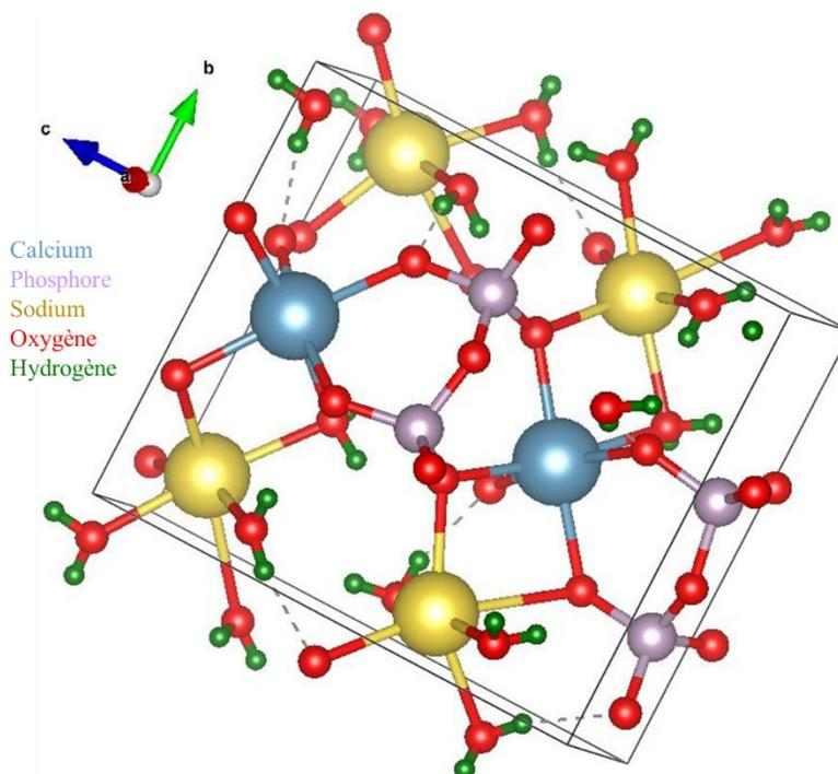
**Figure IV - 11 : Représentation tridimensionnelle de la maille élémentaire monoclinique de la canaphite  $\alpha$  synthétisée, avec placement des atomes d'hydrogène en considérant les données de diffraction des RX et neutrons**
