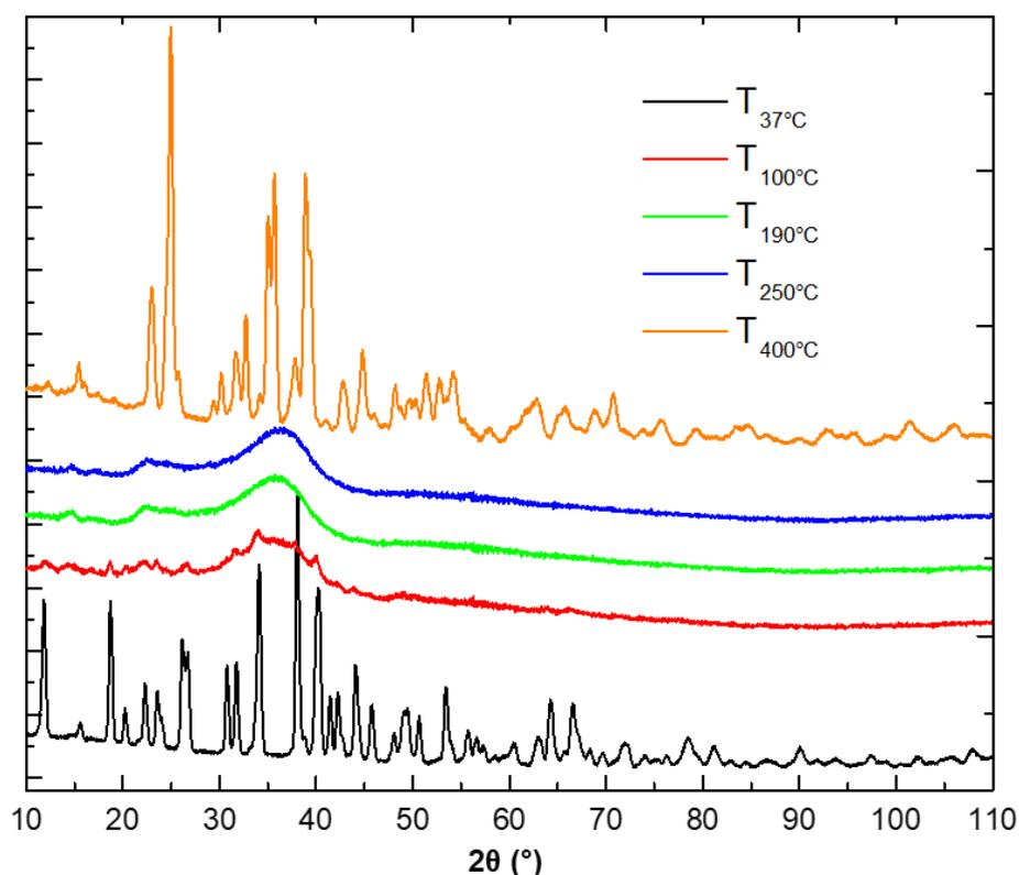
**Figure IV - 12 : Diffractogrammes de Rayons-X (anticathode Cobalt :  $\lambda(K\alpha) = 1,788970 \text{ \AA}$ ) des matériaux élaborés dans les conditions de la canaphite  $\alpha$  mais séchés à différentes températures.**
