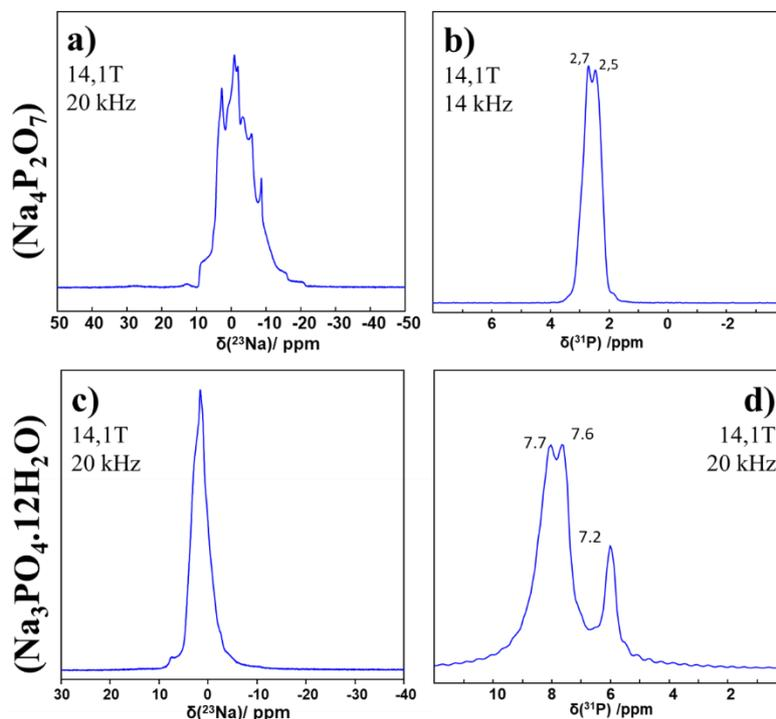
**Figure II - 3 : Spectres RMN du solide des noyaux  $^{23}\text{Na}$  (a et c) et  $^{31}\text{P}$  (b et d) des précurseurs phosphatés ( $\text{Na}_4\text{P}_2\text{O}_7$  et  $\text{Na}_3\text{PO}_4 \cdot 12\text{H}_2\text{O}$ , respectivement) utilisés pour la synthèse de NaPYG-0X0.**
