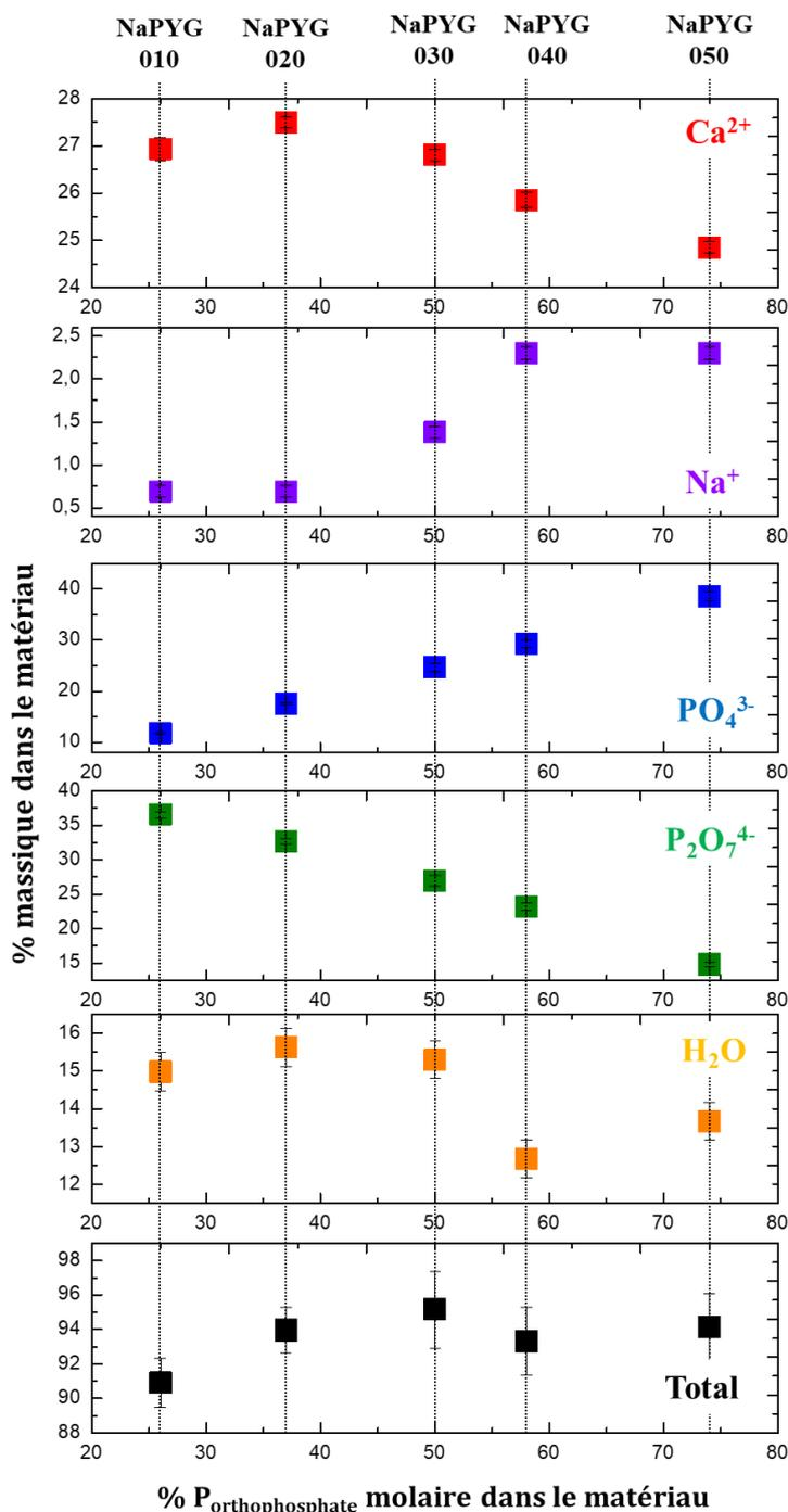
**Figure II - 14 : Evolution du pourcentage massique des ions Ca<sup>2+</sup>, Na<sup>+</sup>, PO<sub>4</sub><sup>3-</sup>, P<sub>2</sub>O<sub>7</sub><sup>4-</sup> (déterminés par RMN du solide) et de l'eau ainsi que de leur contribution totale dans les matériaux NaPYG-0X0 en fonction de leur % de phosphore dans l'orthophosphate par rapport au phosphore total (déterminés par RMN du solide).**
