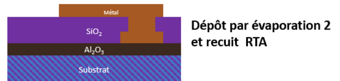
Figure III-9 : Schéma des différentes étapes technologiques nécessaires à la fabrication des électrodes et des chemins d'amenés par photolithographie.
