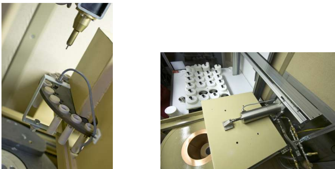
FIGURE 4.13 – Passeur automatique du détecteur puits (à gauche) et détecteur semi-planaire (à droite).
