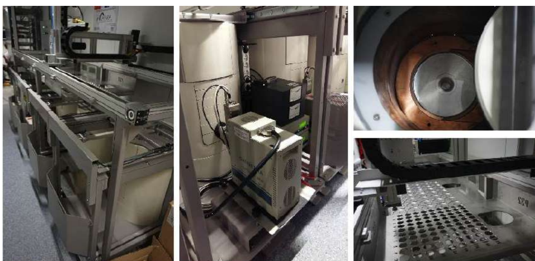
FIGURE 4.12 – Spectromètres bas bruit en fonctionnement au LAFARA. Le passeur innovant est visible sur la photo de gauche. Les cinq spectromètres sont refroidis par cryogénérateur électrique CP5+.
