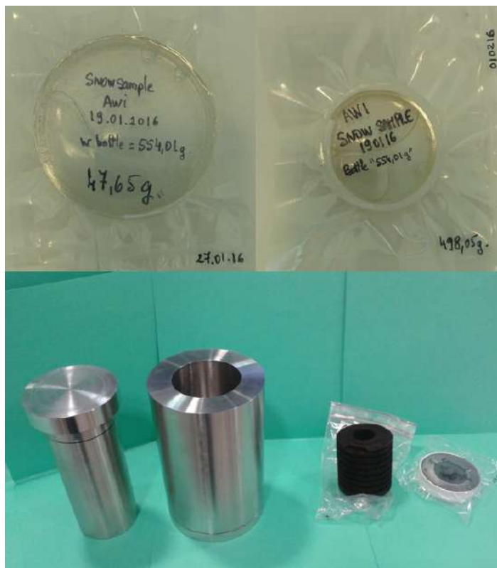
FIGURE 4.14 – Échantillon pour le détecteur semi-planaire de géométrie « large » (en haut à gauche) et de géométrie « small » (à en haut droite) et outils permettant d'adapter la géométrie de la cartouche Mn à la mesure sur le détecteur semi-planaire (en bas).
